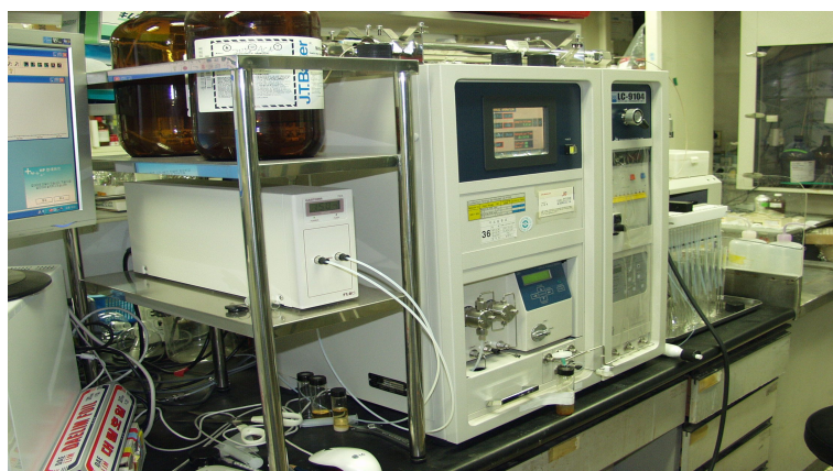
그림 24. Recycling preparative HPLC. 컬럼 : JAIGEL-GS310(20x500mm); flow rate: 4 ml/min; UV-Vis(with RI).
