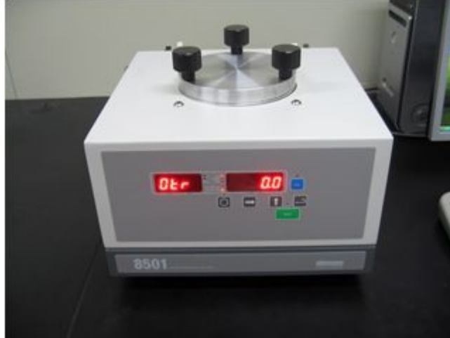
그림 15 OTR측정기를 이용한 필름의 산소투과도 측정
