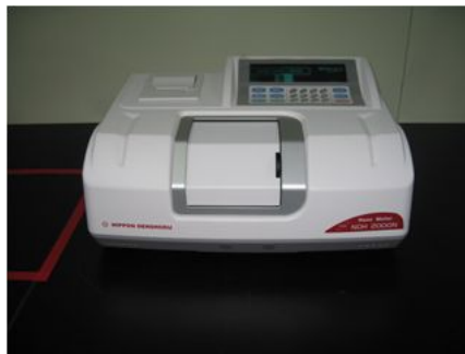
그림 11 Hazemeter를 이용한 필름의 Haze 측정
