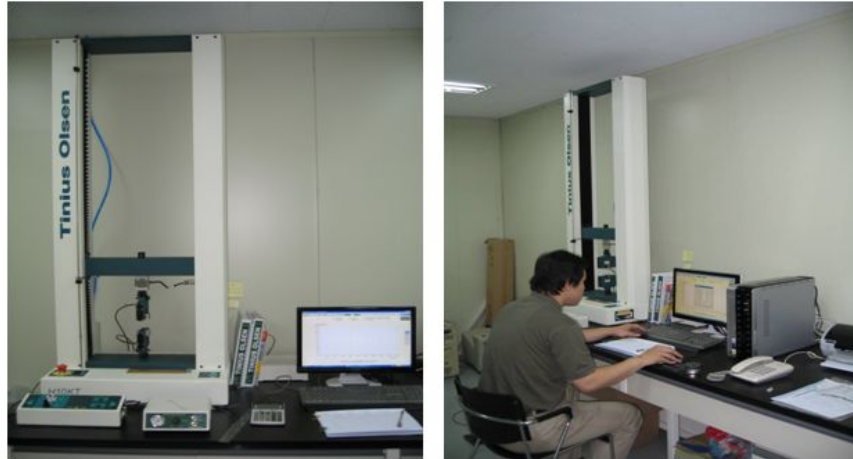
그림 10 UTM을 이용한 필름 시료의 인장강신도 측정
