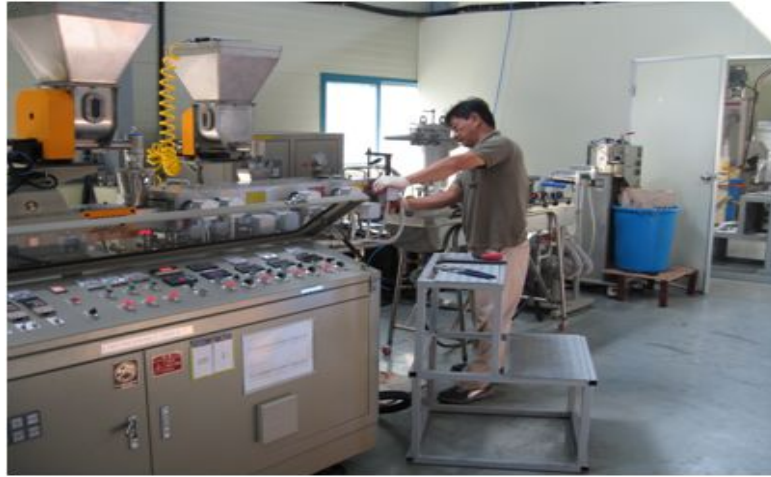
그림 8 Twin screw extruder를 이용한 개질 PLA 컴파운드의 제조
