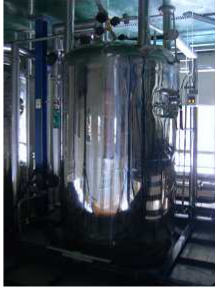
Fig. 5-4. 산업화 규모(5ton scale)의 미생물 배양기
