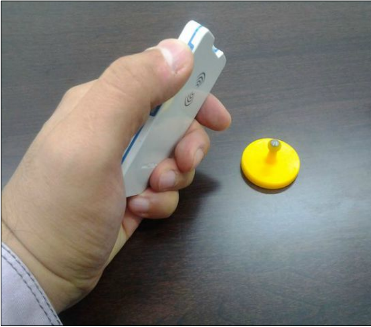
(그림 3-3-40) 블루투스 RFID 리더기를 이용한 태그 읽기다.
