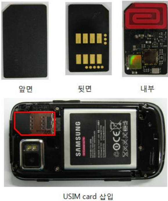
(그림 3-3-38) 스마트폰에 RFID USIM 외형 및 설치
