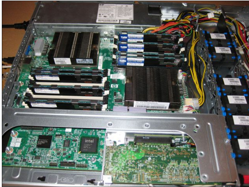
(그림 3-3-7) Server 내부 사진. CPU 2개, RAM 8개 장착
