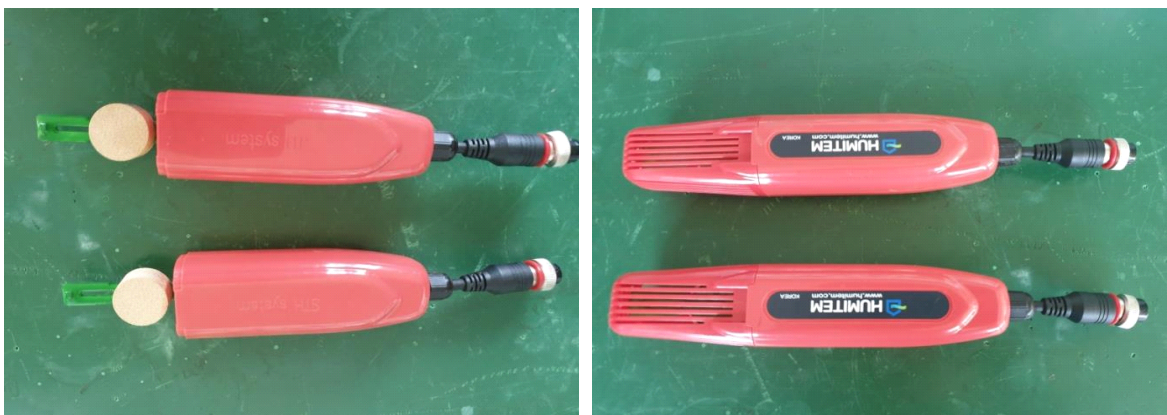
그림 58. 개별 온습도센서 시제품 제작
