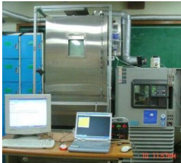
그림 3-17. 박충건조실험을 위한 공기조화장치
