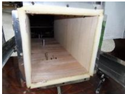
그림 3-55. 건조기에 단열재를 보강한 내부.
