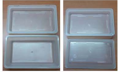
a. 1차 시사출물 b. 2차 시사출물 c. 3차 시사출물 d. 4차 시사출물 e. 5차 시사출물 그림6. 배양용기 시사출물
