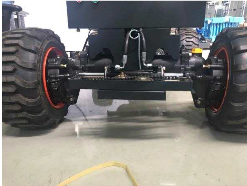
그림 18 전기 운반 농기계의 조향시스템
