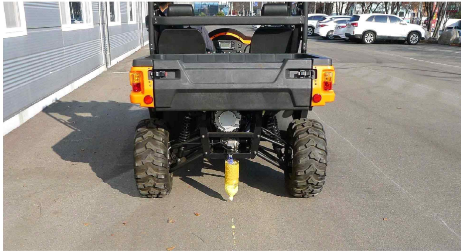
<경로 생성용 Paint-droper 설치(PET병 대체)>
