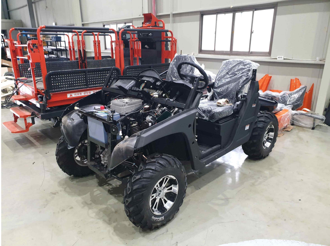
그림 50 사이드 프레임 등 부속 조립
