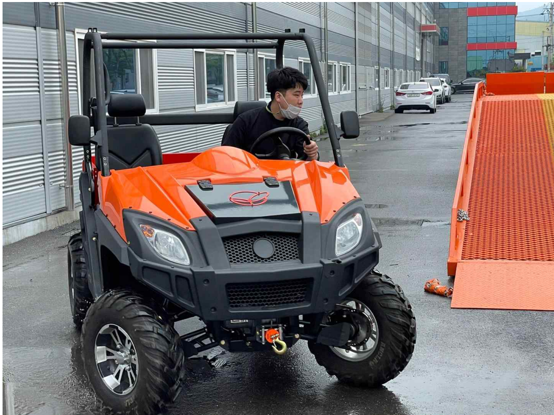
그림 77 선회 주행 시험
