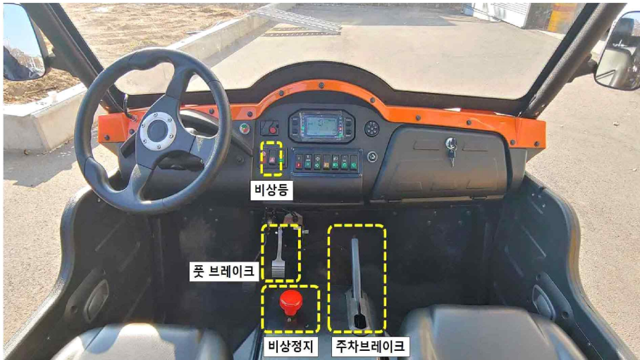
<안전장치 - 비상등, 풋 브레이크, 비상정지, 주차브레이크>
