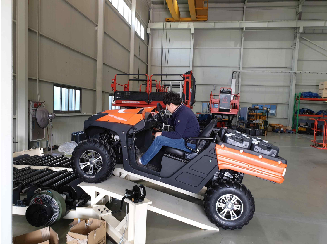
그림 78 적재 및 등판시험
