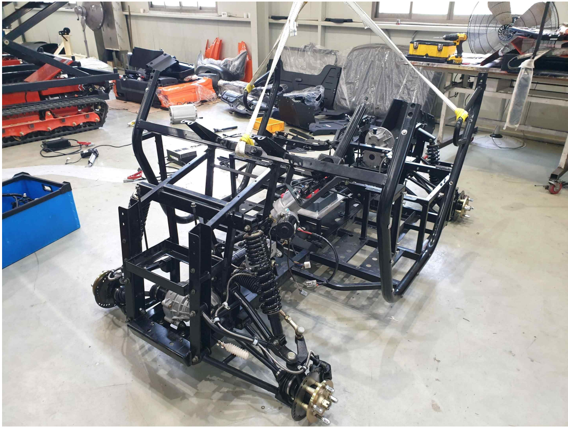
그림 48 동력전달부 및 현가장치 조립
