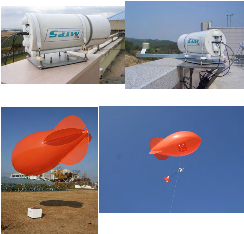
그림 18. 경계층 온도연직분포 측정 장비 초단파프로파일러(상)과 테더존데(하)
