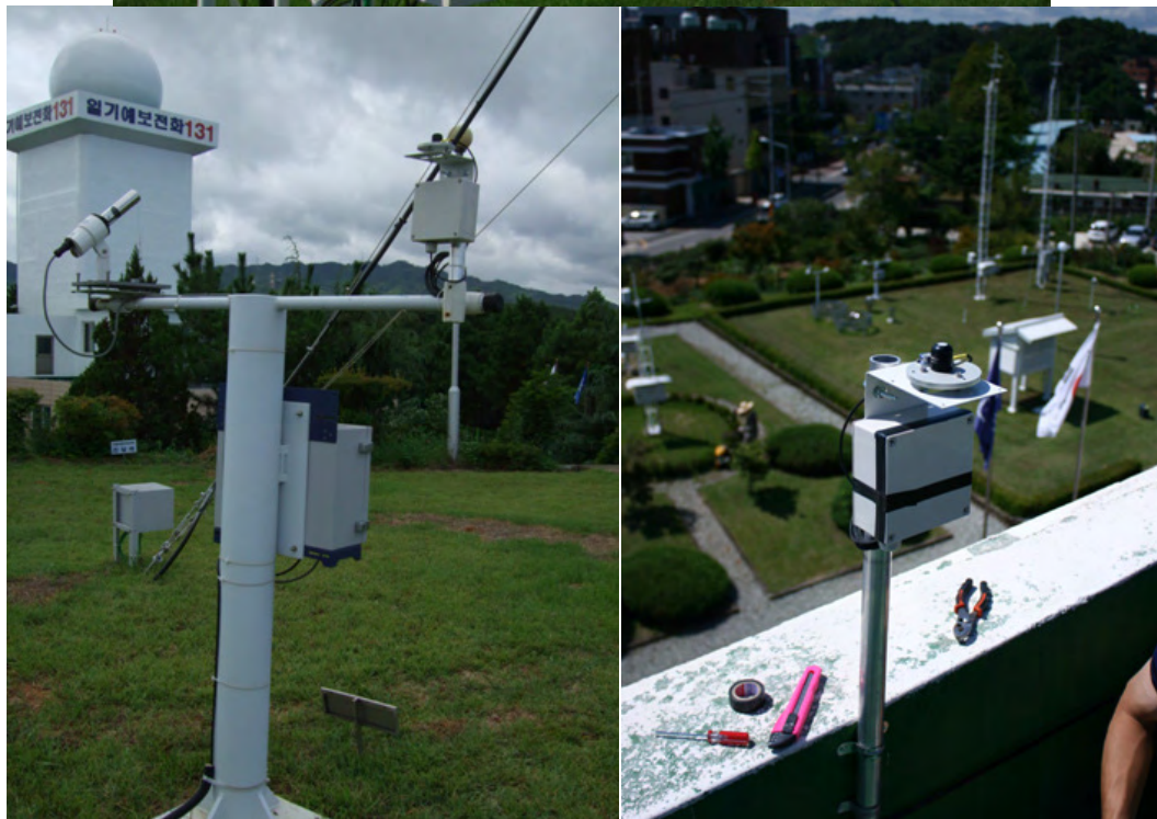
그림 25. 철원기상대(위)와 동해기상대(아래, 좌) 및 안동기상대(아래, 우)에 설치된 간이일사계
