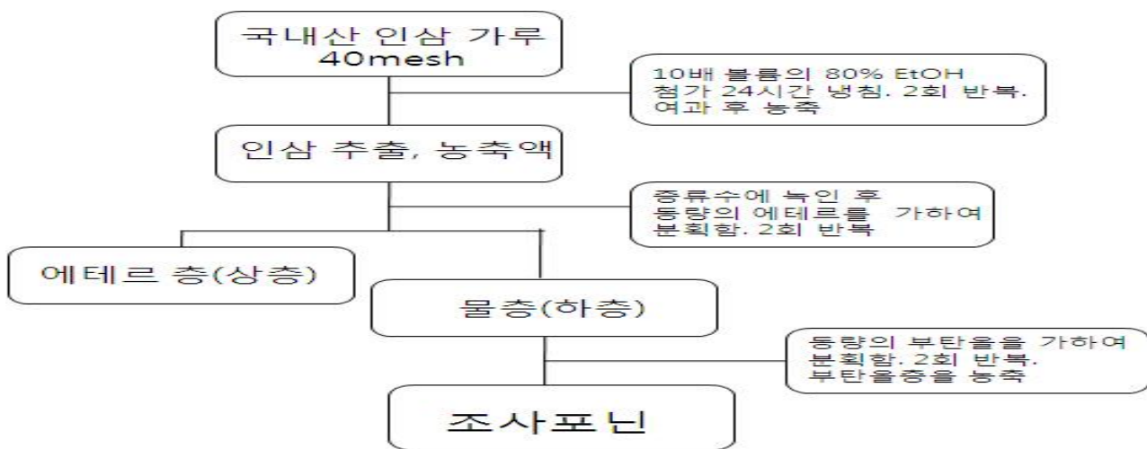
그림 32. 인삼 조사포닌의 제조 방법
