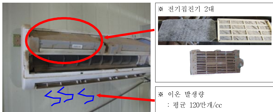
<그림 8> 집진 장비가 보조적으로 부착된 본 공기정화기의 실제 모습
