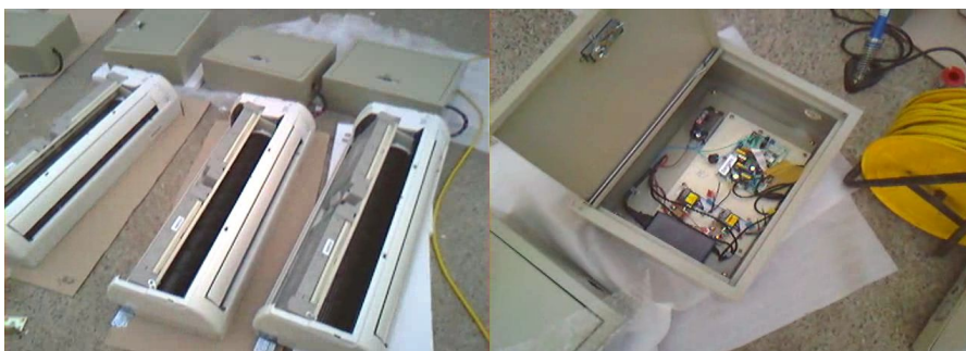
<그림 16> 공기정화기의 제작 및 실험 돈사 내부 설치 모습
