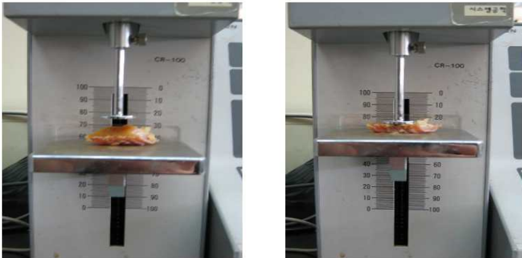
Fig. 5. 열처리된 원료의 어육 및 어골의 물성 특성 분석 장치.
