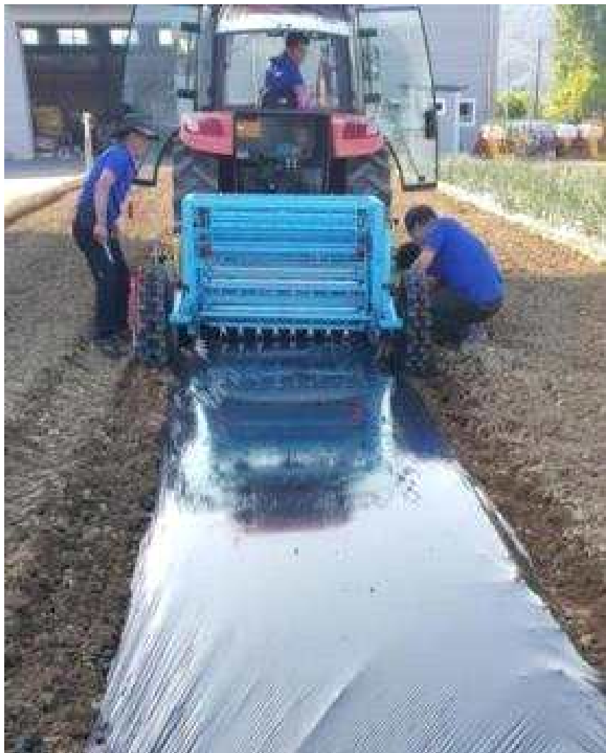
Photo. 19. 로터리, 두둑형성 및 멀칭작업 복합장치 파종기결합 시제품 수정 후 테스트 시연 과정
