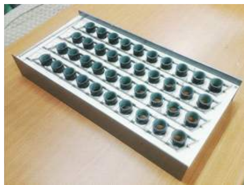
Photo. 5-1 다공 Tray 방식 정렬호퍼 하단의 발근부 하향 직립 종구 홀딩 기구 시제품 제작결과
