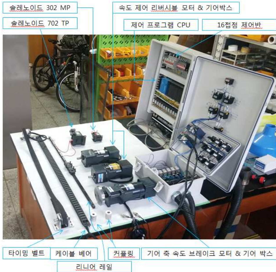
Photo. 5-5 다공 Tray 마늘종구 직립 자동정렬 제어프로그램 및 요소부품 시제품 제작 결과
