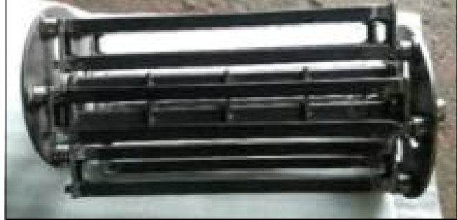
Photo. 4.1.8 회전원판, 회전체 중심축 및 자전 호퍼핑거 프레임 조립 체
