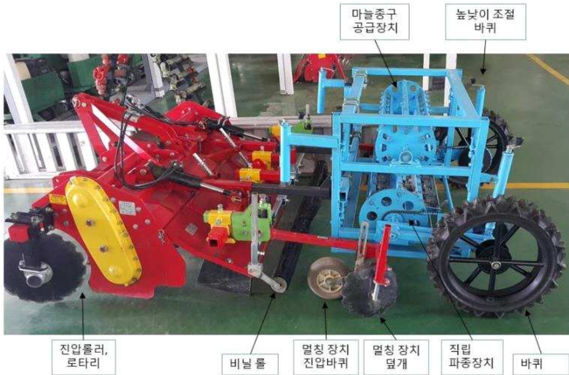
Photo. 16. 로터리 및 멀칭장치와 파종기 시제품의 결합 모습
