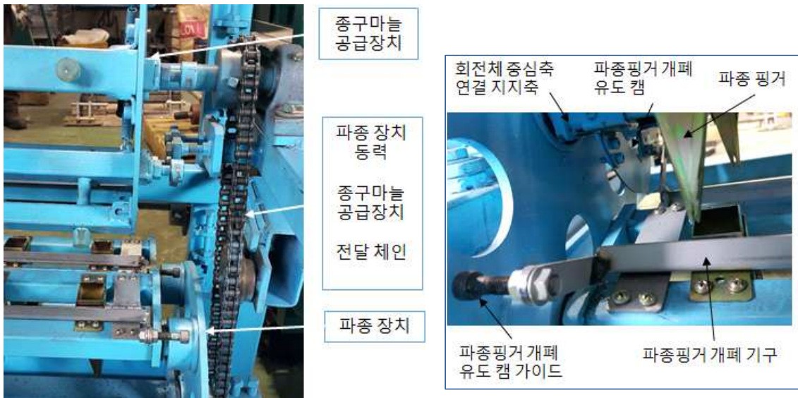
Photo. 6. 파종핑거 개폐 유도 캠, 개폐 유도 캠 가이드 및 개폐기구 설치 상태
