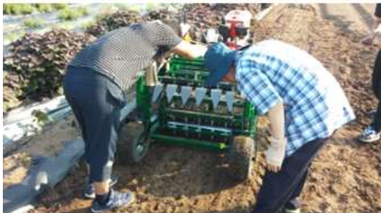
(c) 시제품 시운전 핑거 구멍 형성 정상 상태 점검 (핑거의 플림 유무 점검)
