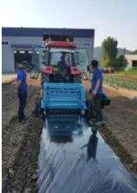
Photo. 17. 로터리, 두둑형성 및 멀칭작업 복합장치 파종기결합 시제품 시연
