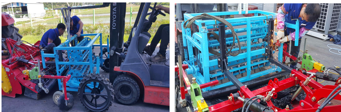
Photo. 18. 로터리, 두둑형성 및 멀칭작업 복합장치 파종기결합 시제품 수정작업
