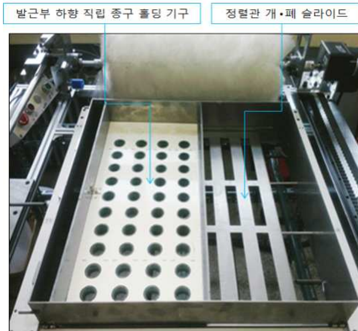
Photo. 5-3 다공 Tray 마늘종구 직립 자동정렬 본체 시제품 제작 결과
