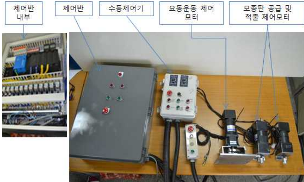
Photo. 5-9 줄 Tray방식의 마늘종구 직립 자동정렬 제어프로그램 및 요소부품 시제품 제작 결과
