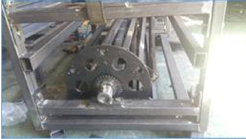
Photo. 2. 마늘종구 직립파송장치 조립 결과
