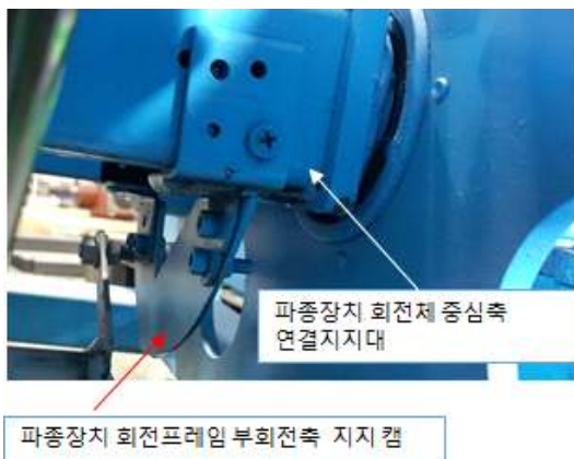
Photo. 7. 부회전축 지지캠 설치 상태
