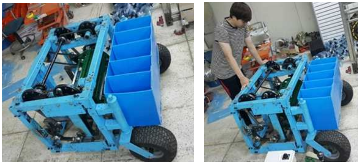
Photo. 4.2.26은 크랭크-링크 기구형 직립파종기 시제품 제작 결과
