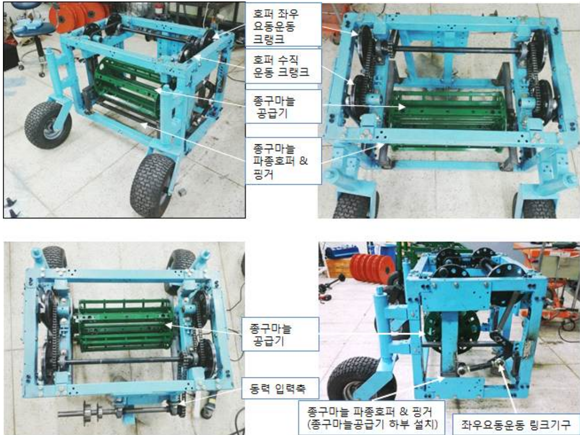
Photo. 4.2.25 크랭크-링크기구형 줄 Tray 배송장치 제외 한 시제품 제작 결과
