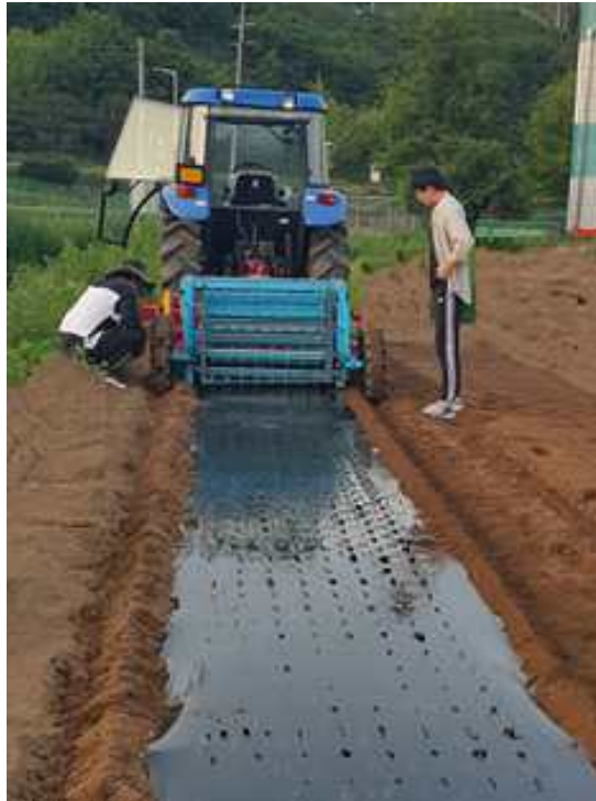
Photo. 26. 직립 마늘종구 '줄 Tray' 미 탑재 상태, 로터리, 두둑, 멀칭작업 결과
