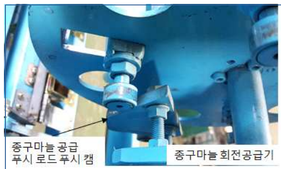
Photo. 8. 종구마늘 공급 푸시로드 푸시 캠 설치 상태
