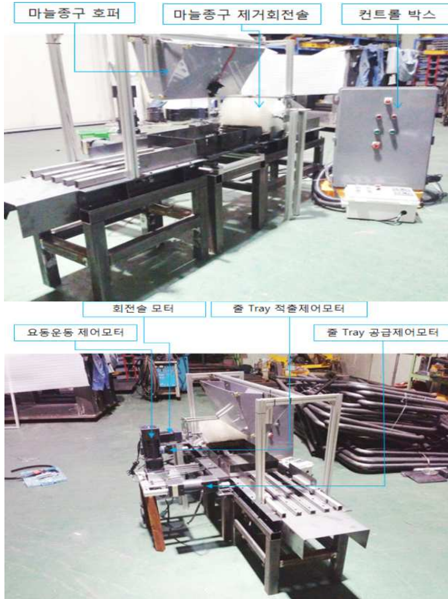
Photo. 5-10 출 Tray 방식의 마늘종구 발근부 하향 직립 자동정렬 기계 완성 시제품 제작 결과
