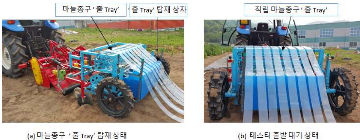
Photo. 28. 시작품 줄 Tray 탑재 상태 와 성능테스터 대기 상태
