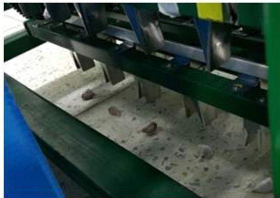
(d) 마늘 종구 투하 후 파종 핑거 상승 상태 (핑거 open 상태 와 지면 수직 상태 점검)
