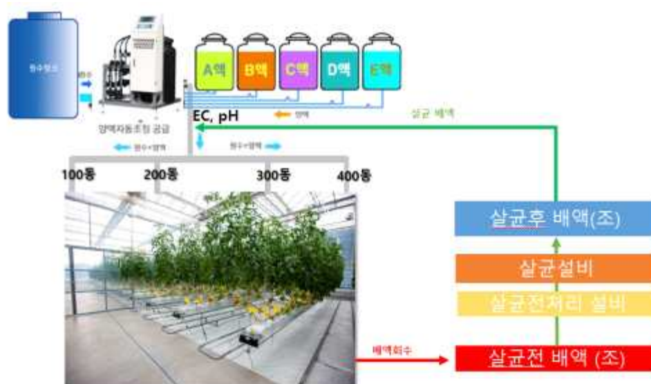
[그림 1.3] 순환식 수경재배 시스템 세부 개념도
