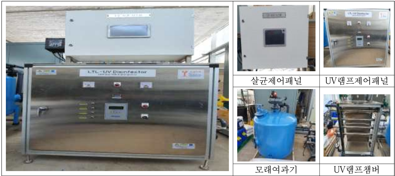
[그림 2.9] UV램프기반의 양액살균장치 시제품(농가실증 적용-6000평)
