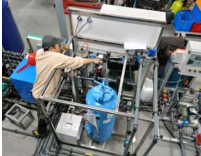
[그림 2.21] 모래여과에서 유량에 따른 역세척 효능을 파악하는 실험 사진
