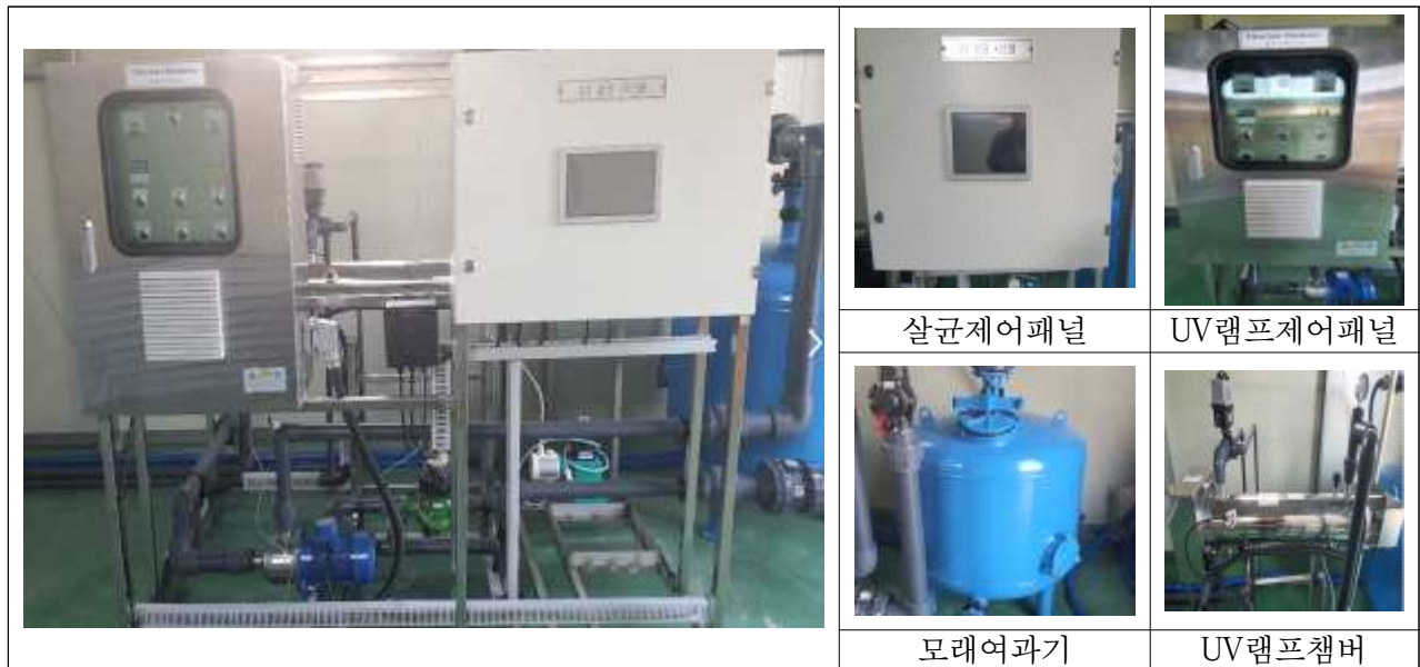
[그림 2.8] UV램프기반의 양액살균장치 시제품(농가실증 적용-2000평)
