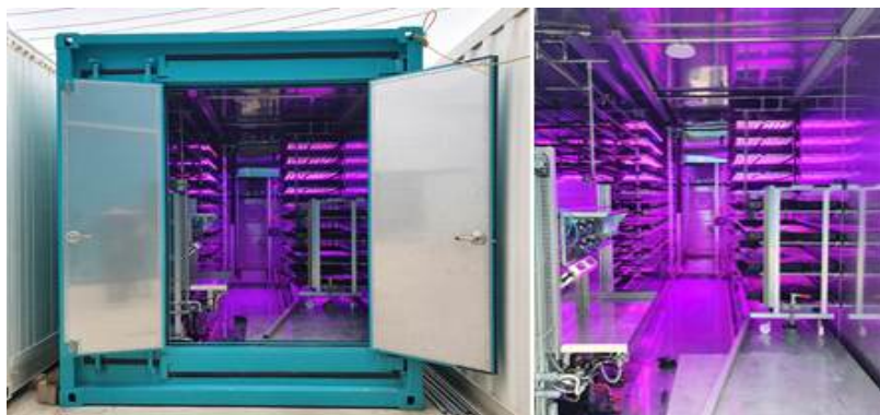
그림 23. 이고들빼기 재배용 컨테이너형 수직농장 식물공장
