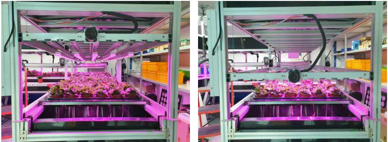
그림 47. 재배단 수동 높낮이 조절 구현 모습
