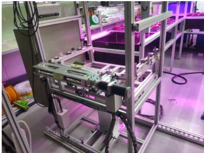
그림 49. 재배단 1층과 2층이동 및 재배트레이 삽입 및 수확시 제거를 위한 이송대차 모습
