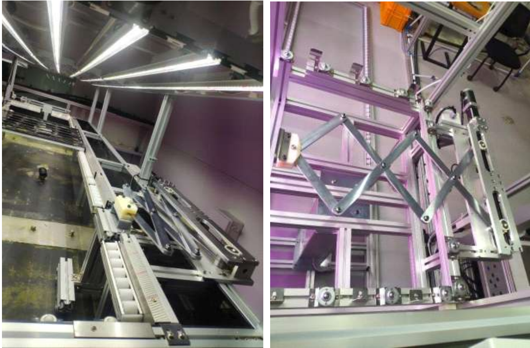
그림 50. 트레이 푸시를 위한 액추에이터 설치 및 동작 시 모습
