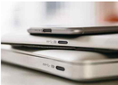
그림 69. USB C타입 수용 핀 형태 (일반적인 스마트패드 및 스마트폰 단자)
