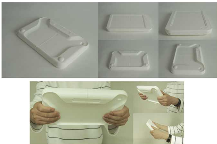
그림 57. 일부 수정된 E Type의 3D 모델링 및 렌더링 예시 및 3D 출력물의 적합성 비교
