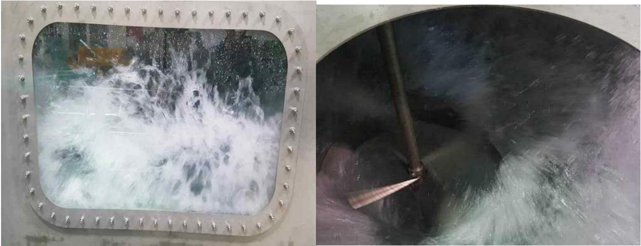
그림 141. 구동부 교반 probe 작동 및 물 공급
