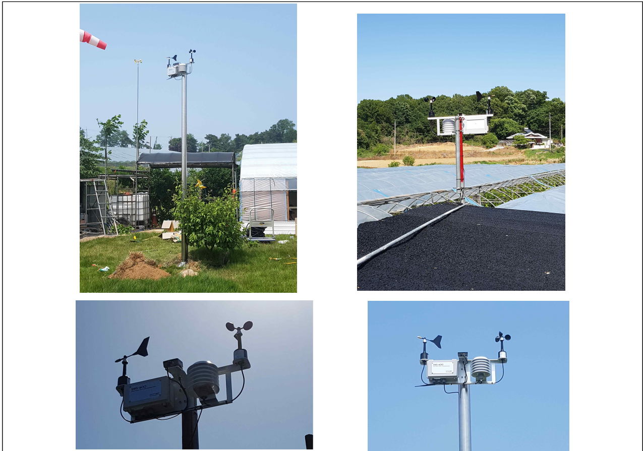
<KS X 3266 표준을 적용한 외부기상대 설치 사진>
