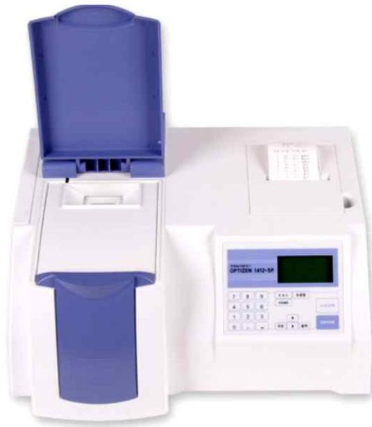
그림 50. 시험에 이용한 퇴비부숙도 판정기
