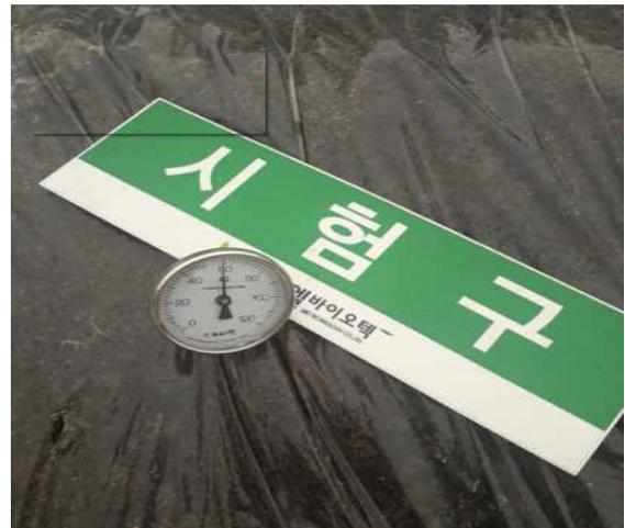
그림 49. 온도측정기를 이용한 측정방법
