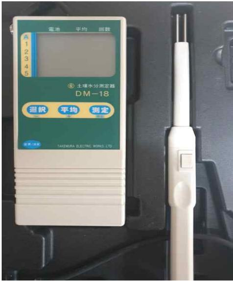
그림 46. 시험에 이용한 수분측정기
