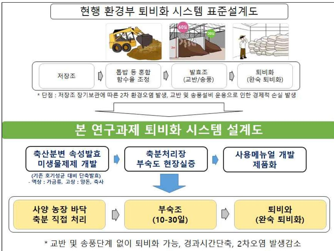
그림 1. 본 연구과제 시스템 설계도 요약
