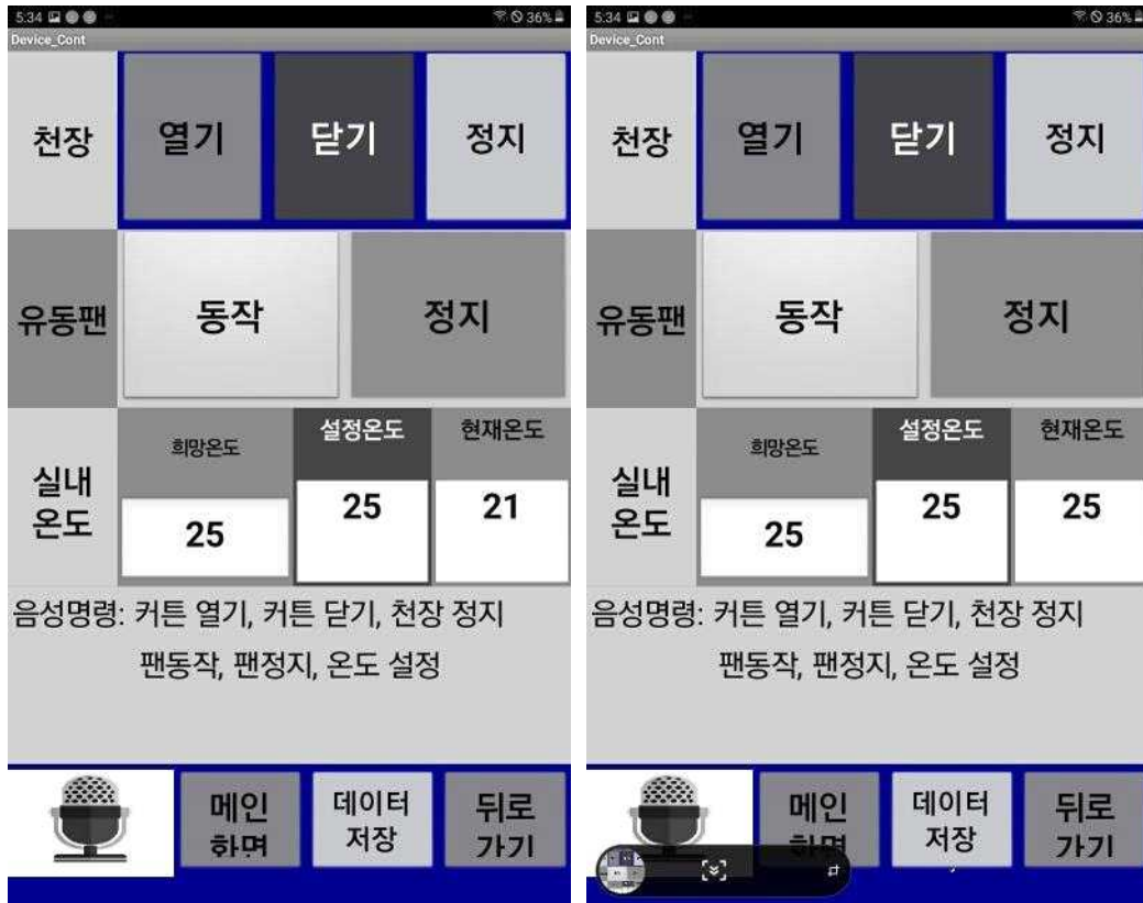
그림 37. 장치제어 화면의 구성 및 현재 온도의 변화 예
