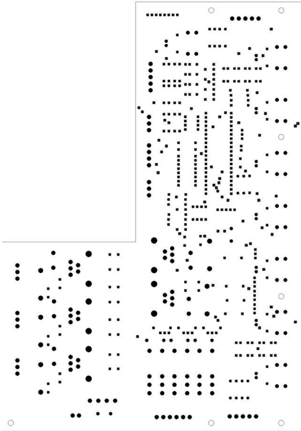
그림 99. 작동기록 및 경보 기관 솔더 마스크도
