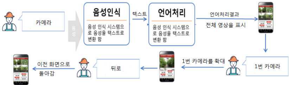
그림 20. 음성인식 시나리오의 구조(카메라 확인의 예)
