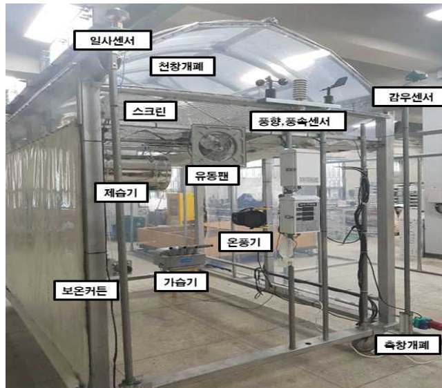
그림 127. 소형 실험온실 내 구동기 및 센서 배치
