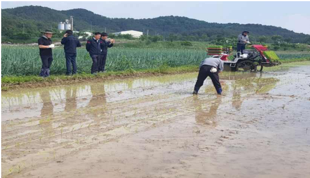
<정도시험 측정 장면> 황이송떼기: 20회, 경심민감도: 표준
