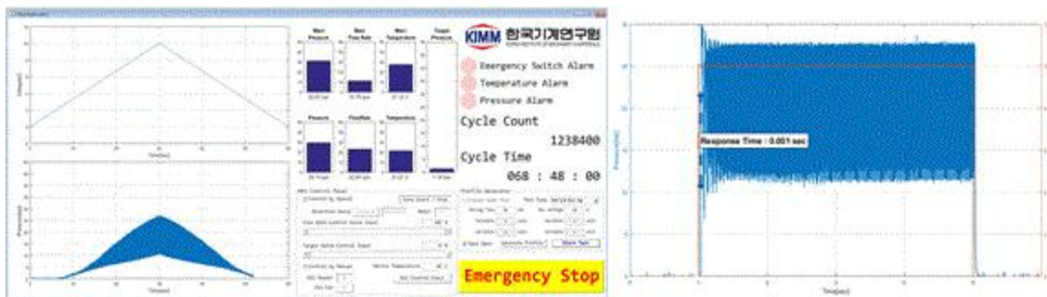
<BM 밸브 성능 시험 채터링 발생>
