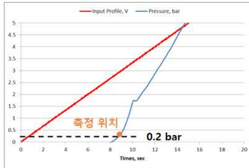
<작동입력시작 전류범위 시험 측정 방법 >
