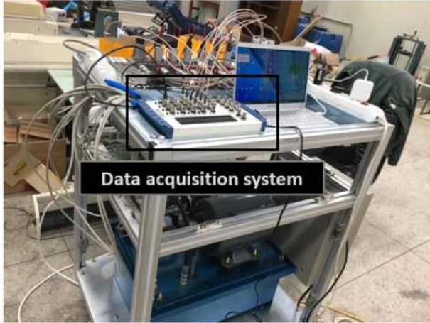
<워크벤치 데이터 계측 시스템(좌) 및 LabVIEW를 이용한 실시간 데이터 계측(우)>
