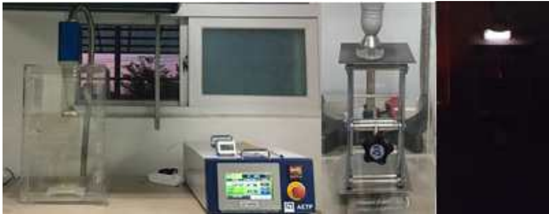
<그림2-8> lab scale 플라즈마 시스템(왼쪽), 플라즈마 처리 모습(가운데)과 발생된 플라즈마 불꽃(오른쪽)
