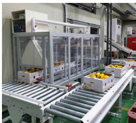
<그림2-137> 상용화용 플라즈마 시스템 적용 플라즈마 처리
