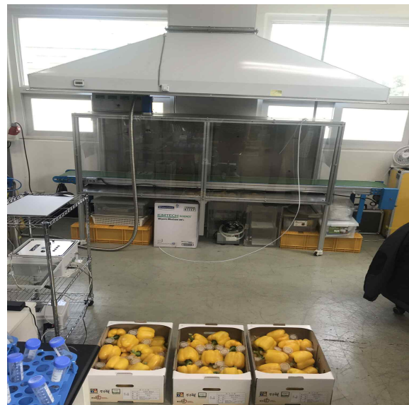
<그림2-132> 파프리카 처리용 플라즈마 기반 전처리 장치.
