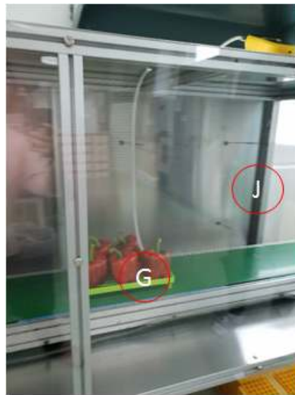
<그림2-49> 대용량 플라즈마 시스템의 챔버내 플라즈마 처리 위치(G and J site)
