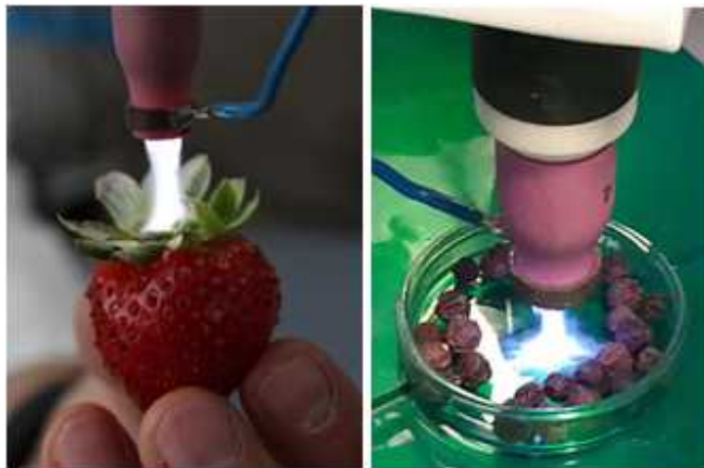
<그림1-12> 딸기 꼭지 살균(왼쪽)과 후추 살균을 위한 플라즈마 제트 방식 적용
