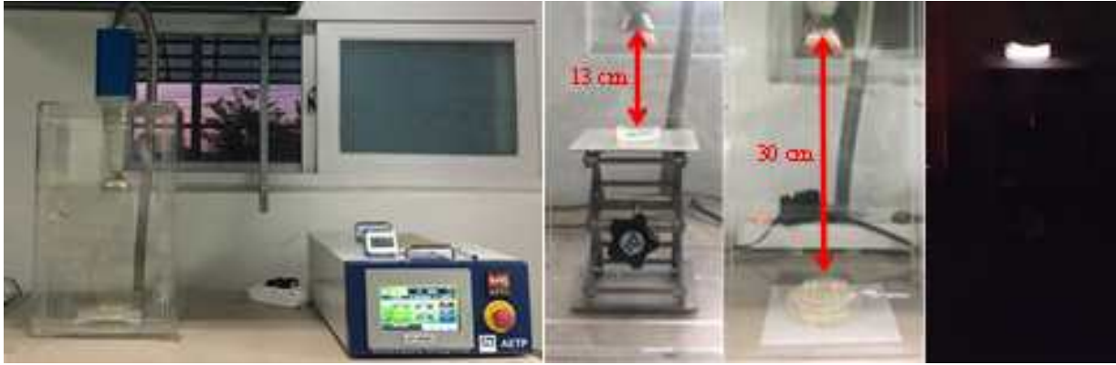
<그림2-10> lab scale 플라즈마 시스템(왼쪽), 플라즈마 처리 거리(가운데)와 발생된 플라즈마 불꽃(오른쪽)
