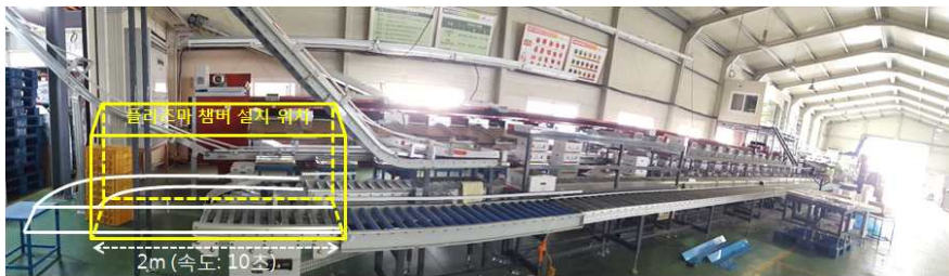
<그림2-122> 조은그린(주) 선과라인에 설치할 상용화용 플라즈마 시스템 위치 계획도(초기계획)
