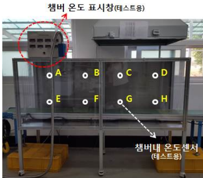
<그림2-45> 대용량 플라즈마 시스템의 챔버내 온도 측정 센서 위치(8곳, A~H) 및 온도 표시 박스
