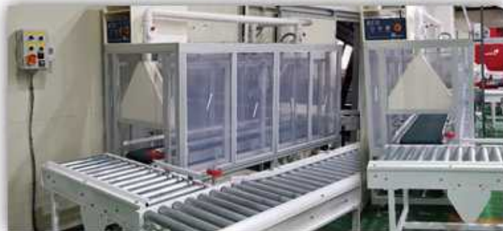
<그림2-133> 조은그린(주) 선과장 내 상용화용 플라즈마 시스템
