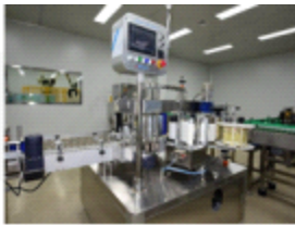
11. 라벨링 : 날인기를 이용해 라벨에 유통기한을 인쇄한다. 날인된 라벨을 제품에 떨어지지 않게 부착한다
