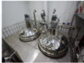
2. 당화 : 투입한 원료를 가열시켜 당액을 만든 후 엿기름을 투입하여, 당화과정을 거친 후 저장한다
