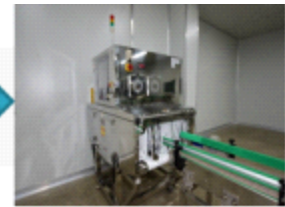
12. X-ray 검출공정 : X-ray 검출기를 통과하여 제품의 이물질을 찾아낸다.
