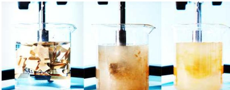
그림 12. 종이의 알칼리 해리성 및 분산성 시험 과정
