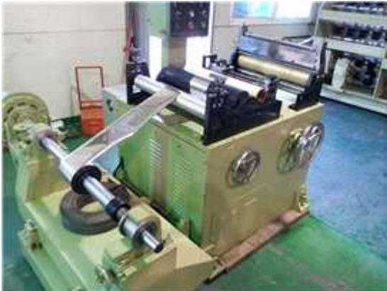
그림 23. 슬리터 설치 전경
