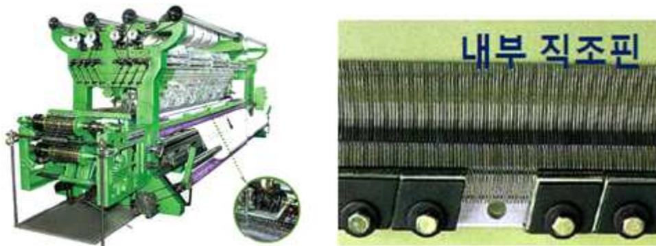
그림 5. 직조기 모습 및 주요 핵심 부품인 직조핀
