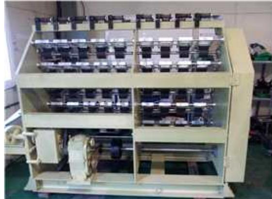
그림 24. 슬리터 크릴장치 설치 전경
