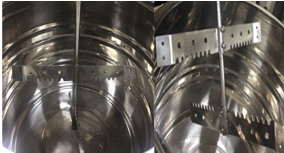
그림 38. 교반 장치 내 블레이드
