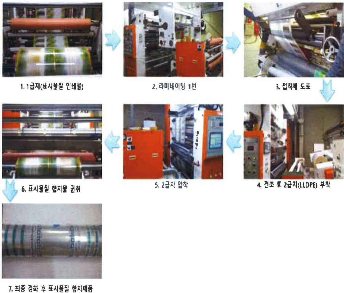
그림 32. 표시물질 Dry Laminating 공정 흐름
