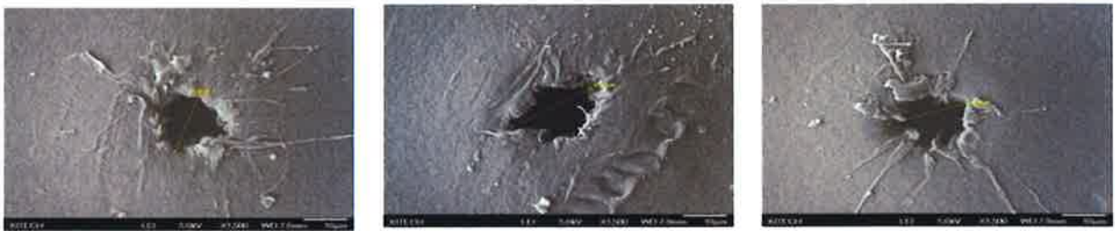
그림 38. PET 12 \mu\text{m} + LLDPE 30 \mu\text{m} 2펄스 SEM형상 (Hole Size 19 \mu\text{m} )
