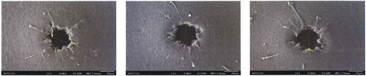
그림 37. PET 12 \mu\text{m} + LLDPE 30 \mu\text{m} 1펄스 SEM형상 (Hole Size 17 \mu\text{m} )
