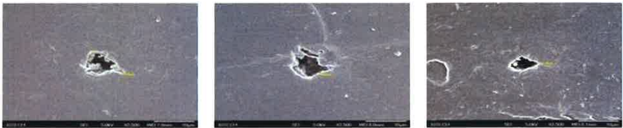
그림 39. PET 12 \mu\text{m} + LLDPE 40 \mu\text{m} 1펄스 SEM형상 (Hole Size 9 \mu\text{m} )
