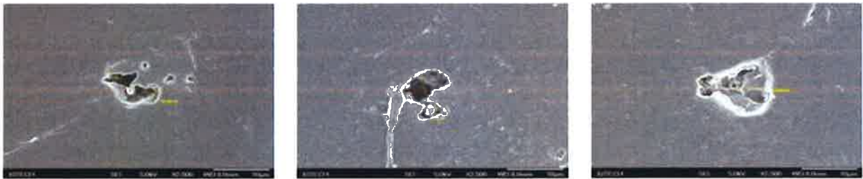
그림 40. PET 12 \mu\text{m} + LLDPE 40 \mu\text{m} 2펄스 SEM형상 (Hole Size 10 \mu\text{m} )
