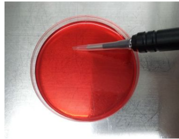
그림 95. 자성펜 및 tip을 활용한 선택배지에 균접종 과정 (tip은 실리콘으로 제작되어 agar 배지에 부드럽게 접촉되도록 됨)
