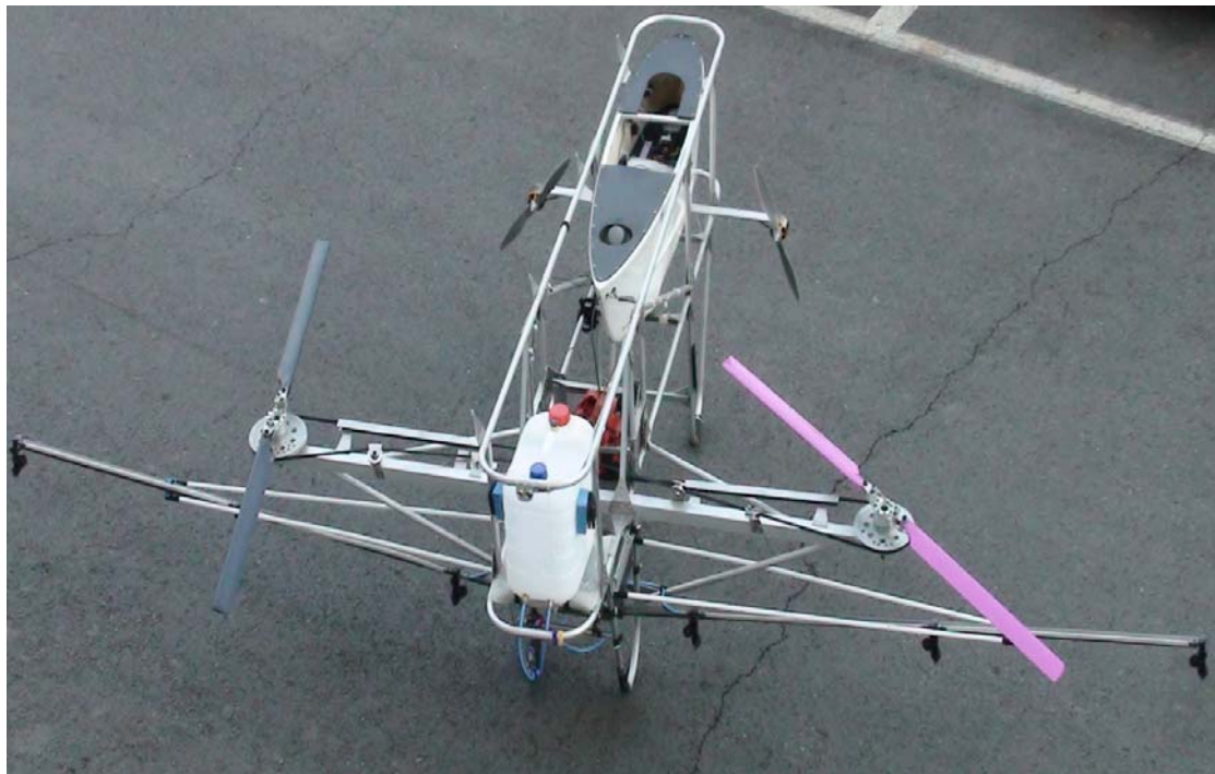
그림 43. 최종 제작된 비행선 하부 구조물
