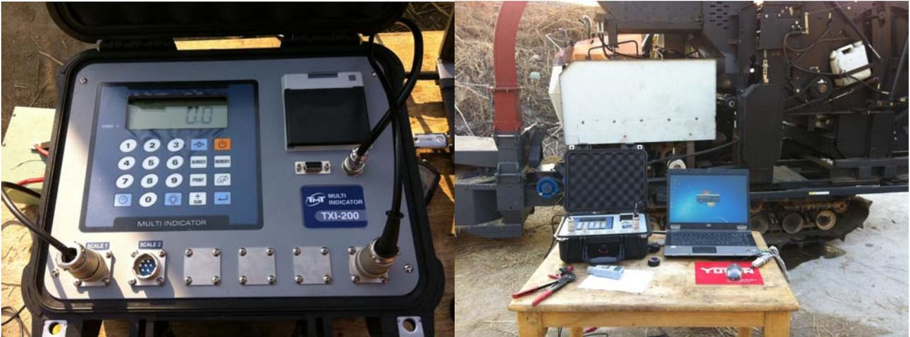
그림3-38. 동력측정장치(토크, 회전수)의 설치
