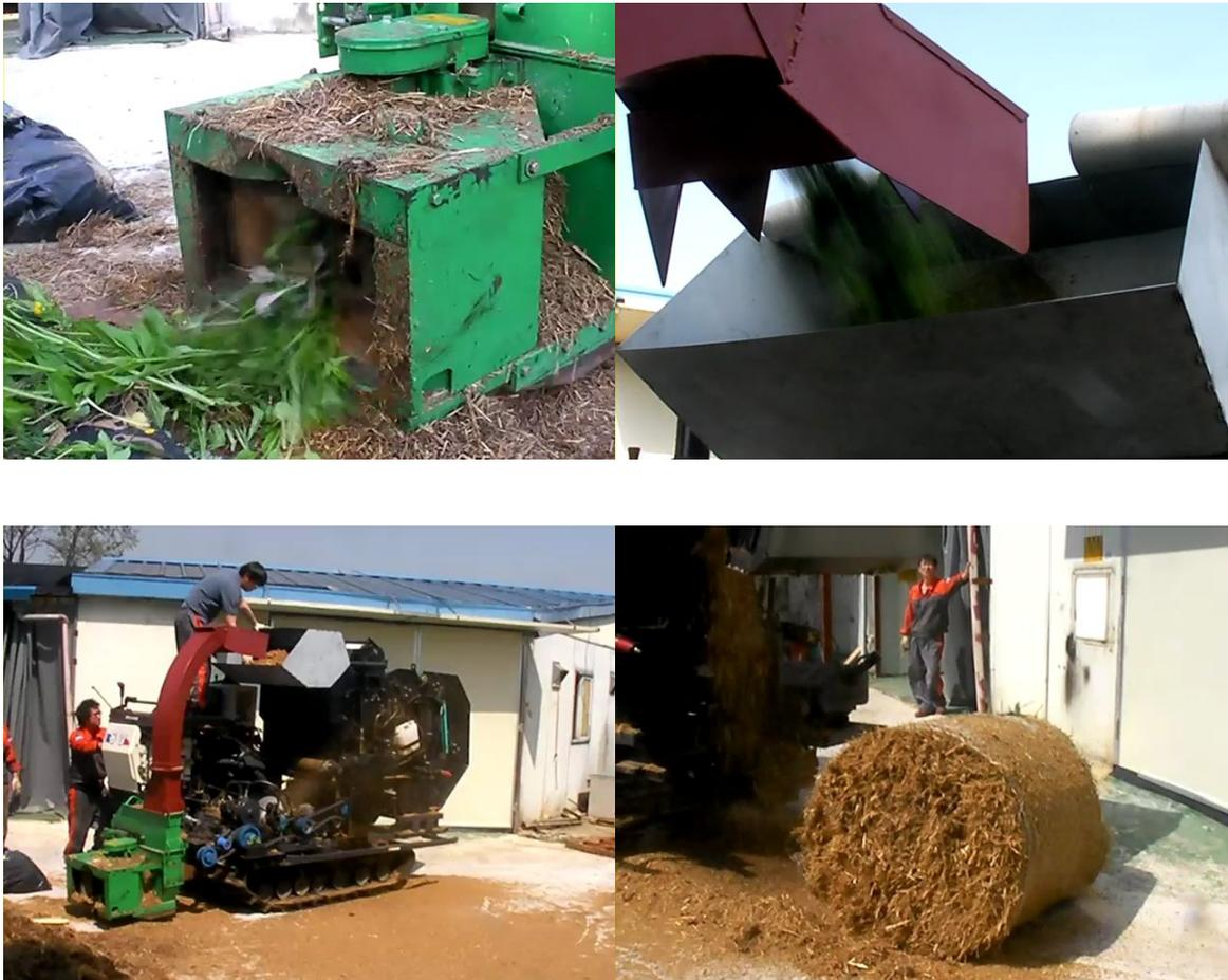
그림3-24. 개발된 장치로 베일링작업 진행 및 제조된 베일뭉치의 사진
