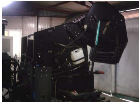
그림 3-12 자주식 차대에 탑재된 베일링 장치
