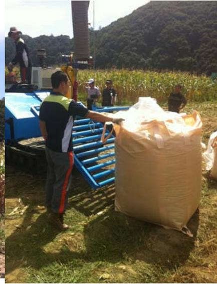
그림3-41. 자주식 수확동시 원치타입 톤백사일로 제조기의 필드실험 및 연시
