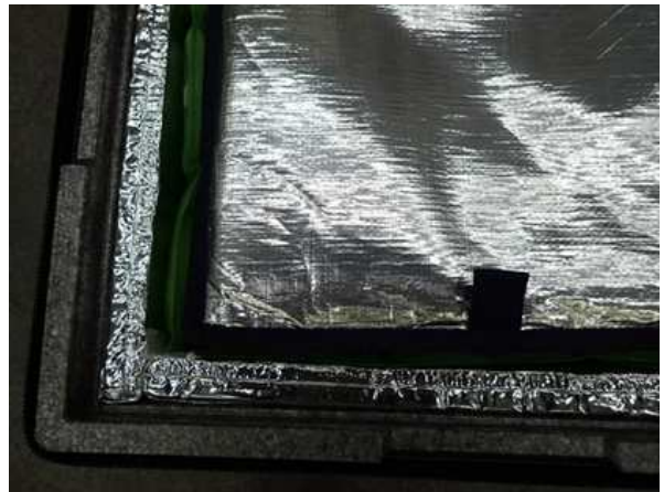
그림. PCM과 용기가 결합된 모습 - PCM 모양이 일정하지 않음
