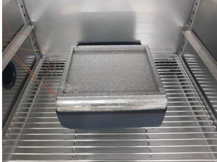
그림. 내부 적재 공간이 부족한 모습 - 용기가 튀어나옴
