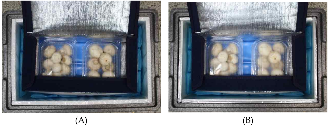
그림. 단열 박스 적용 버섯 샘플 사진 (A) EPP box with EPS panel; (B) EPP box with VIP
