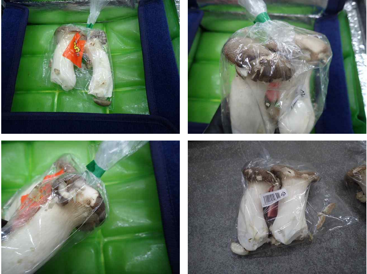
그림. 낙하시험 중 이상 발생 모습 - 버섯류 파손
