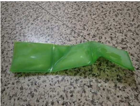
그림. PCM과 용기가 결합된 모습 - PCM 모양이 일정하지 않음
