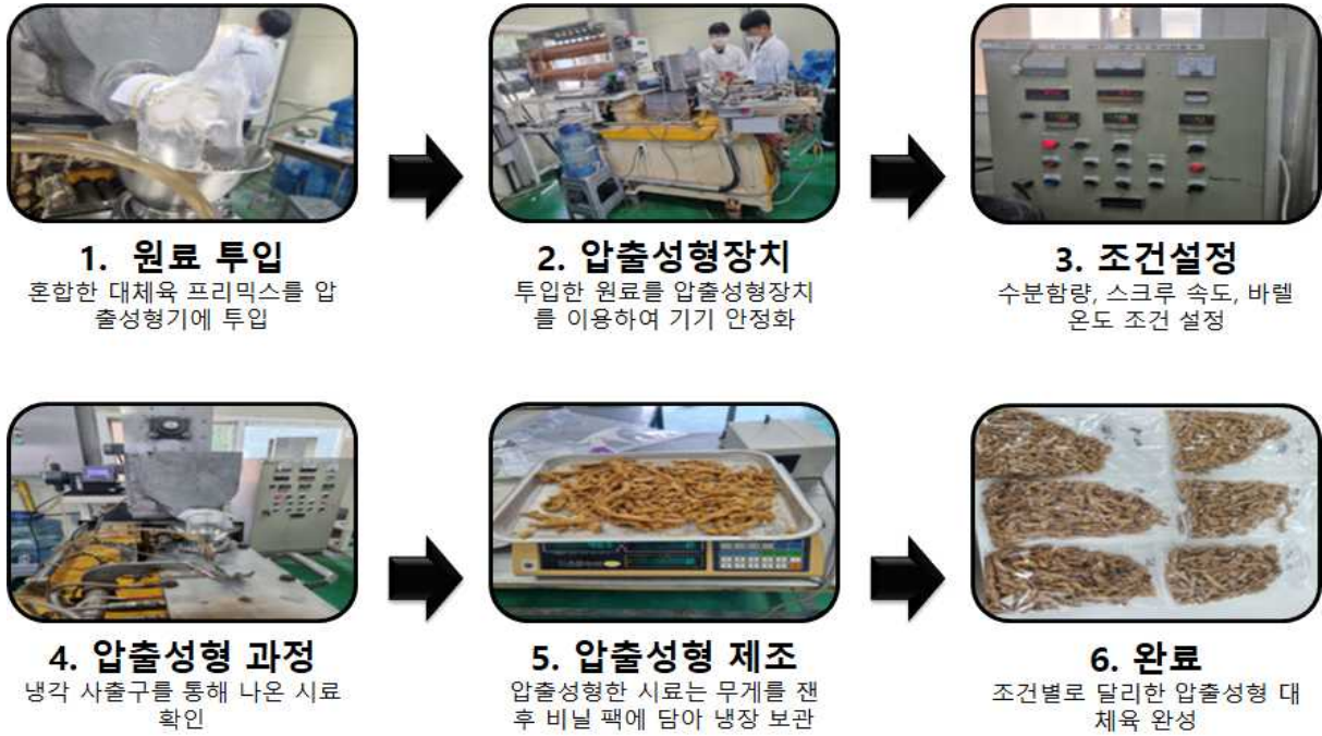
그림 32. 압출성형 대체육 제조 공정
