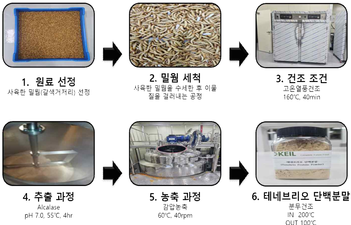
그림 31. 밀웜(갈색거저리) 단백질 분말 제조 공정
