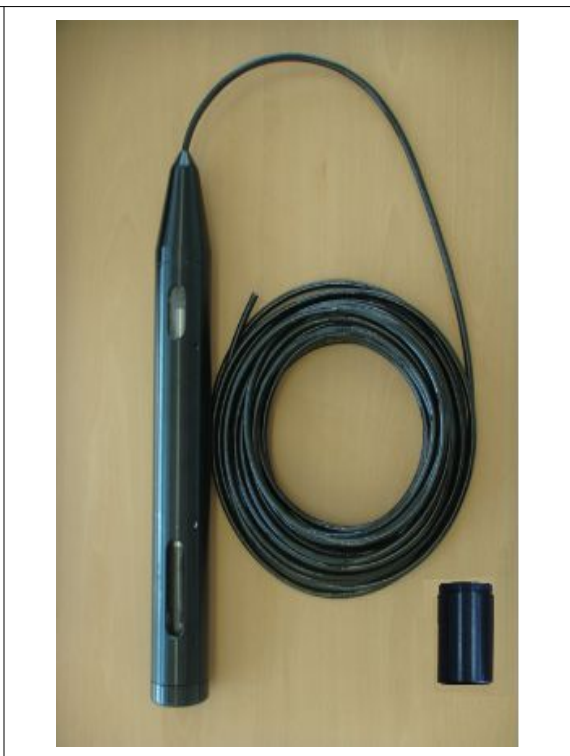
<그림 3-17> 하우징 및 센서 장착 사진
