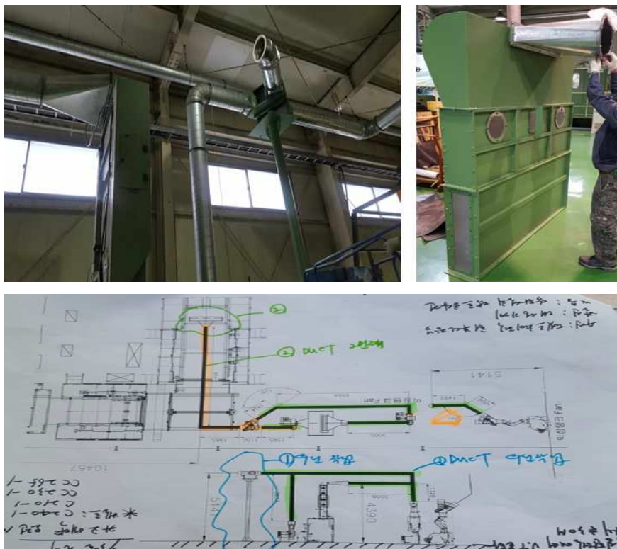
Fig. Fine-Opener 경로를 생략하여 원사 이송
