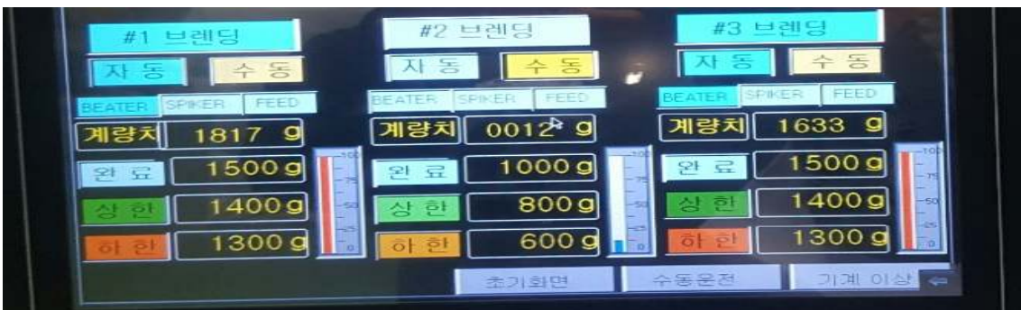
Fig. Blending별 계량측정산포 보정 제어 장치
