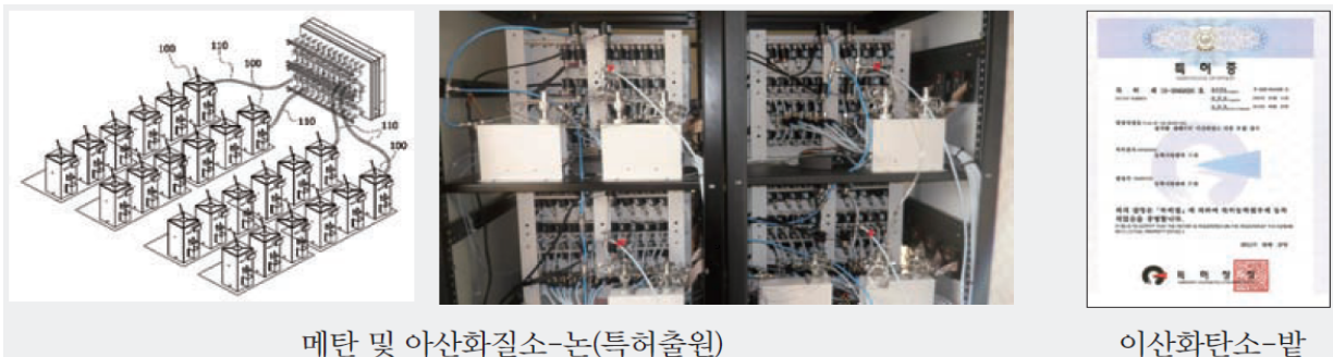
[그림3-11] 온실가스 배출량 자동측정 시스템
