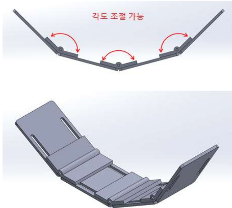
그림 40. 센서 각도영향 테스트를 위한 지그 설계안
