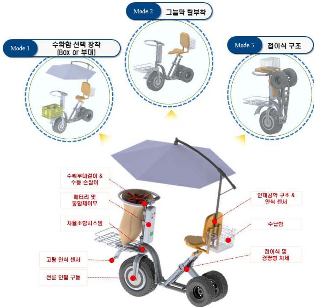
그림 1. 자율조향 시스템이 적용된 수확용 전동플랫폼 개념도
