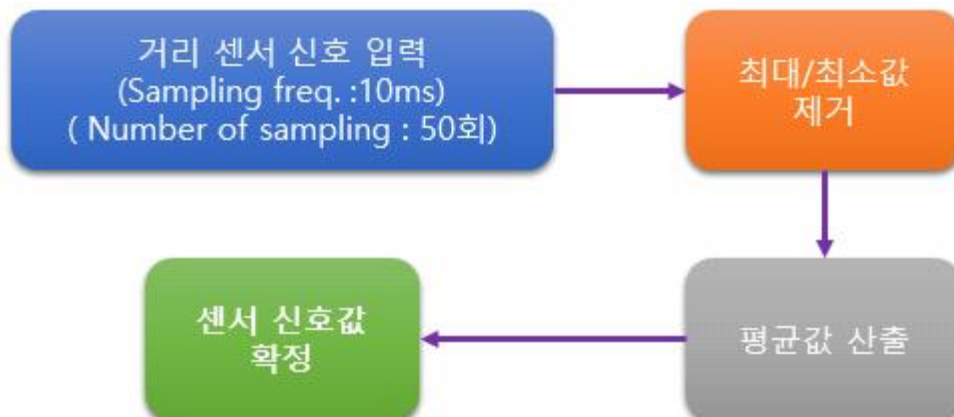
그림 28. 센서모듈 신호값 필터링 블록도
