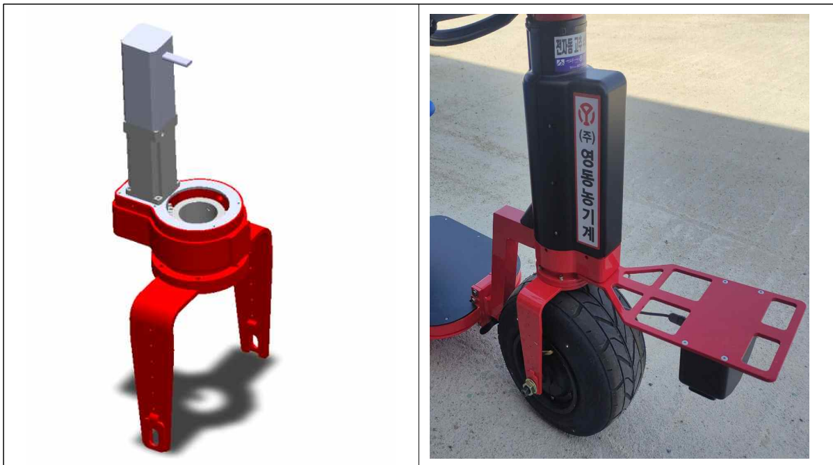
그림 57. 조향 모터 및 감속기 설계
