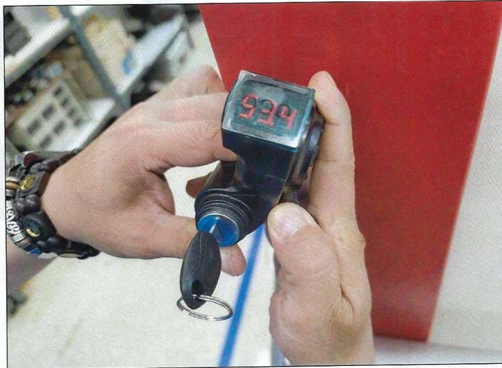
그림 11. 내한 시험 온도 30 분 방치 후 직진 구동 확인을 위한 스트롤 조작 확인 장면
