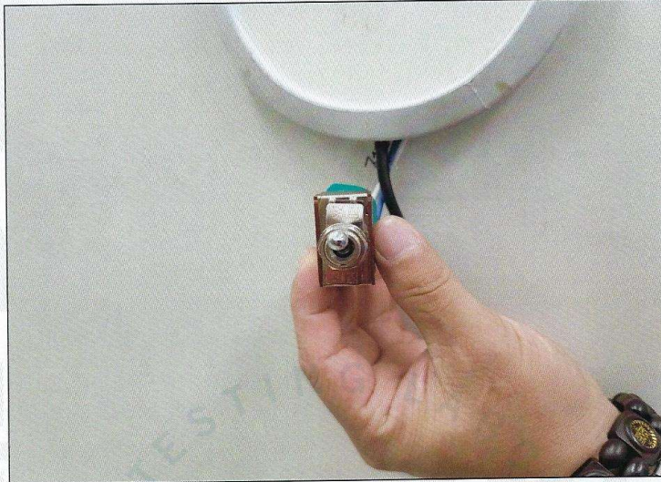
그림 10. 내한 시험 온도 30 분 방치 후 직진 구동 스위치 설정 확인 장면
