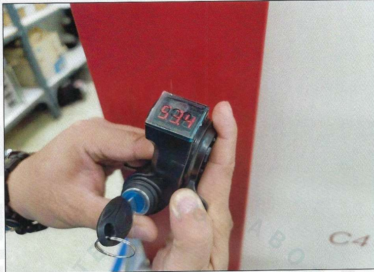
그림 14. 내한 시험 온도 30 분 방치 후 후진 구동 확인을 위한 스트롤 조작 확인 장면
