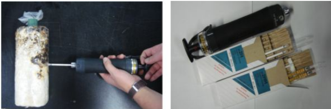
그림 1. 배지 내부 가스 측정(좌), 기체채취기와 검지관(우)
