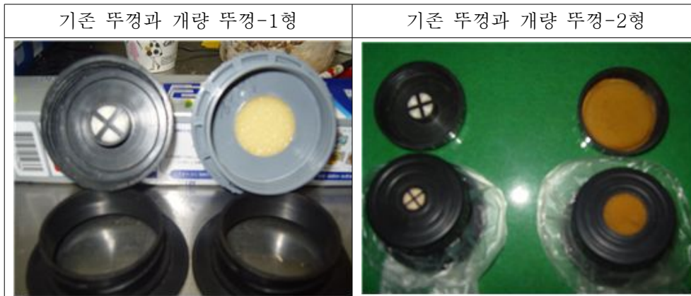
Fig. 2. 기존 코튼볼 삽입된 뚜껑과 개량된 뚜껑의 도식
