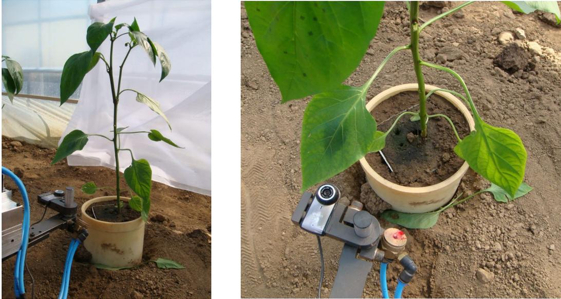
그림 로봇11. 로봇의 수평 팔이 수평으로 자란 잎에 접근하는 모양, 왼쪽: 접근 전, 오른쪽: 근접한 경우
