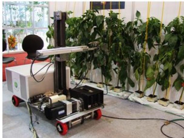
그림 로봇2. 제작된 자율 분사로봇의 사진.
