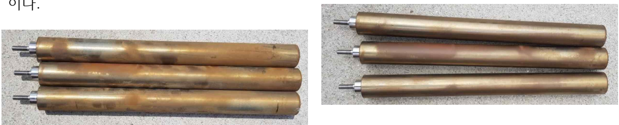
그림 13. STS316 히터코어(좌) 부식 및 STS316+Cu/Pd/Pt 다중도금 히터코어(우) 부식
