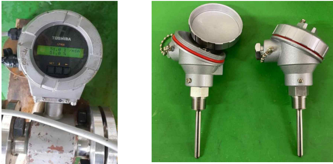
그림 5. 마그네틱 체적유량계 및 RTD온도센서
