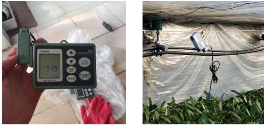
그림 3. 실험용 하우스 내부에서 온습도 센서 및 설치모습
