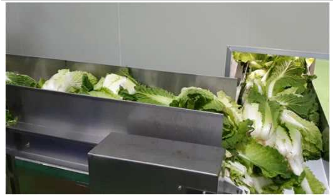
- 배추 씻기 장치에 의해 씻어진 배추를 배추 절단 공정으로 옮기는 컨베이어 그림40. 씻어진 배추의 다듬기공정 이송 컨베이어
