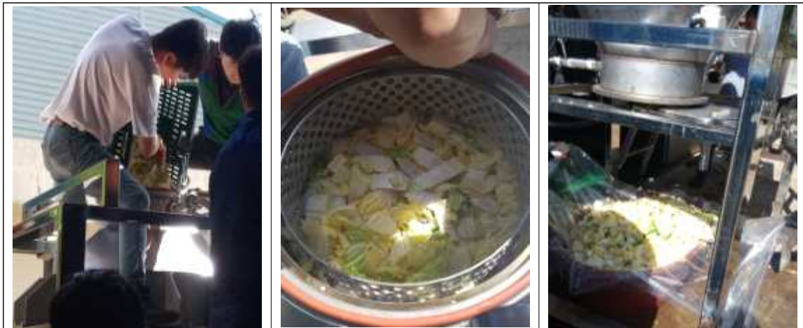
그림8. 상하개폐 가압순환 절임테스트 (좌: 배추투입, 중: 절임준비, 우: 절임배추 배출)
