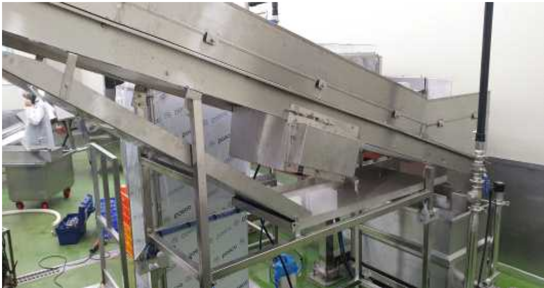
그림33. 살수된 썰은 배추의 이송컨베이어와 염수받침대 및 염수회수통
