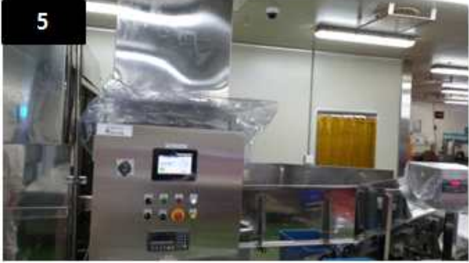
그림14. 상부투입 상부배출 가압연속절임기의 구조와 문제점
