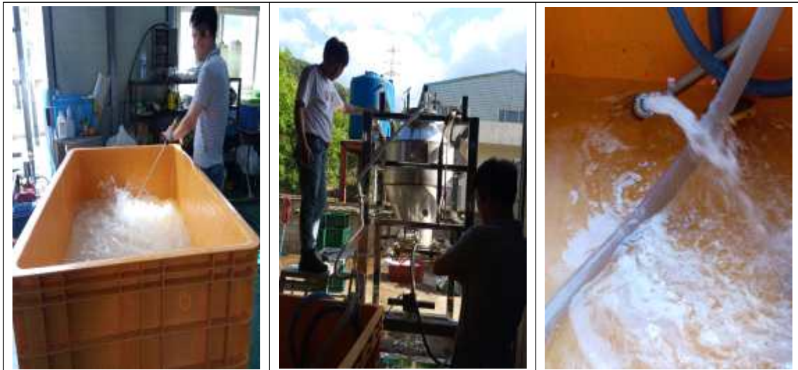
그림7. 상하개폐 가압순환 절임테스트 (좌: 염수제조, 중: 염수투입, 중: 염수배출)
