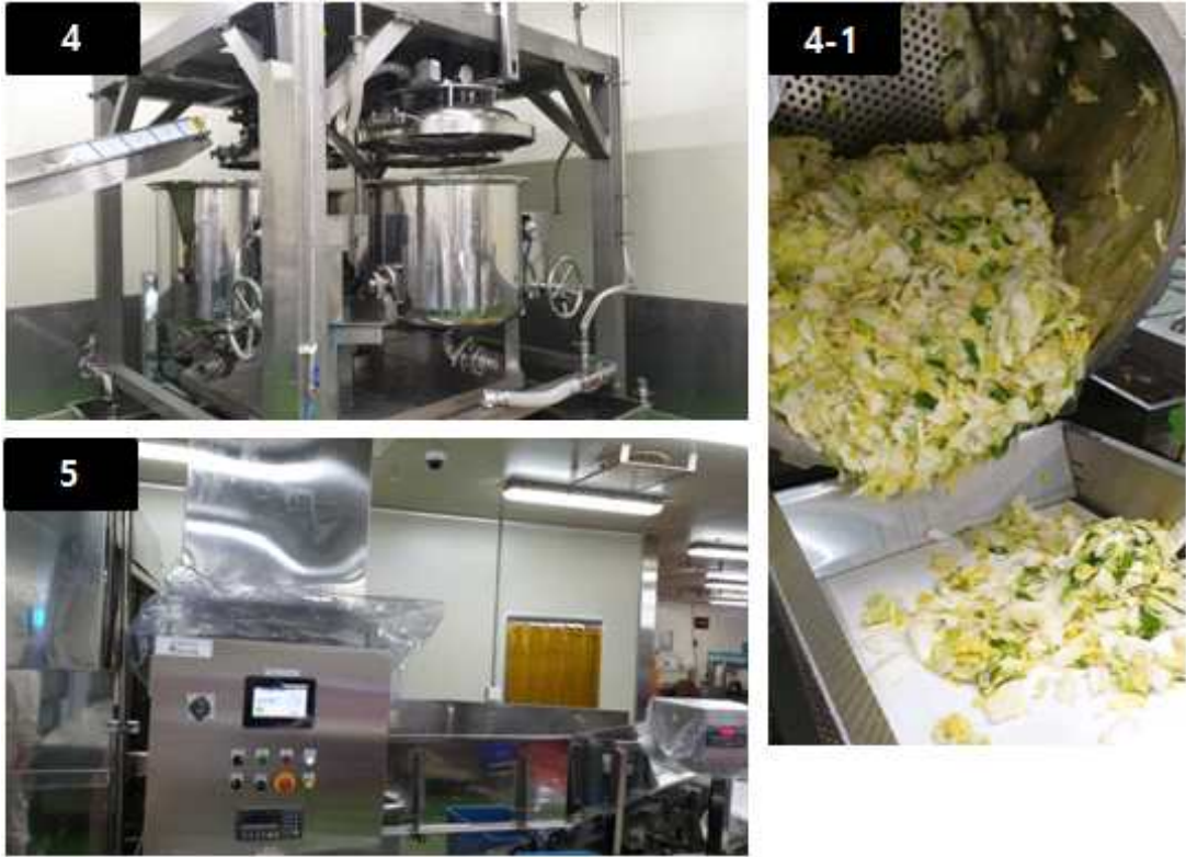
그림46. 밀폐순환 가압연속절임기 및 연속 혼합 공정 4: 밀폐순환 가압연속절임기, 4-1: 절임배추 쏘기, 5: 연속 혼합 공정
