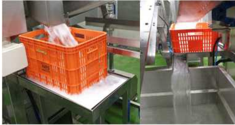
그림32. 염수살수장치의 배추 슬러지 거름 및 염수 회수 탱크
