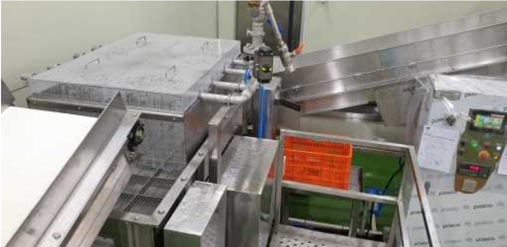
그림30. 썰은 배추 염수 살수 장치
