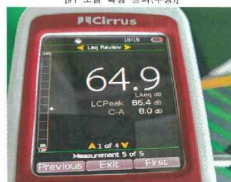
그림 17. 소음 시험 수행 결과
