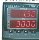
[#1 최대 회전속도 시험 사진]
