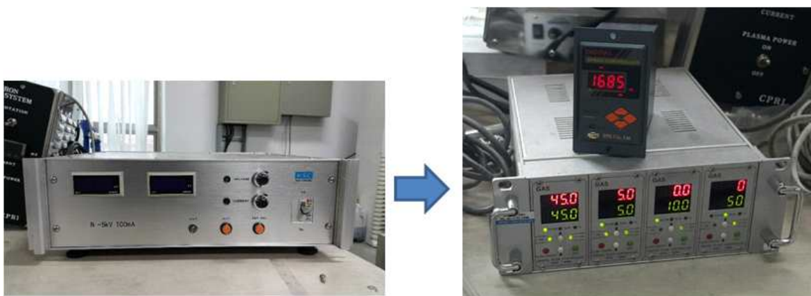
그림 92. 플라즈마 시스템의 컨트롤 부분 개조 전(왼쪽)과 개조 후(오른쪽)
