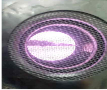
그림 93. 100W에서 아르곤:산소(9:1)의 비율로 공정 진행한 플라즈마 방전 상태
