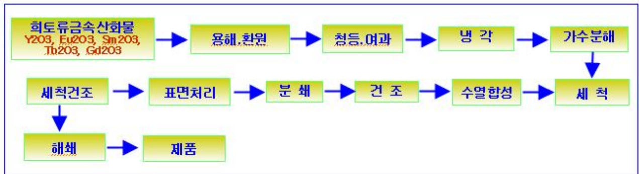
그림 5. 수열합성법을 이용한 광변환 무기포스포 나노입자 제조 방법의 모식도
