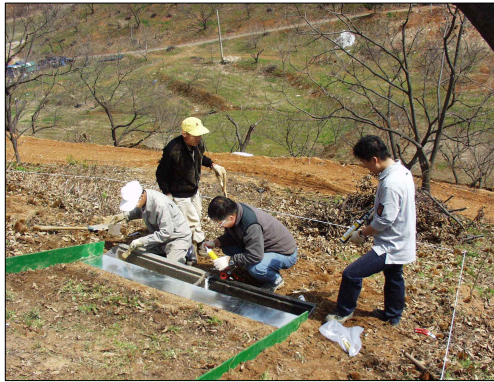
그림 2-19. 멀칭효과 시험지내 lysimeter 설치 전경 (좌: lysimeter 설치 장면, 우: lysimeter 설치 후)
