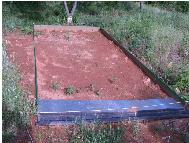
그림 2-9. 초경재배 조사구내 토사유출량 시험구 설치
