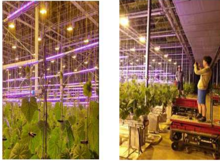
그림 47. HPS 및 LED 인터라이팅 합성광원을 적용한 테스트베드
