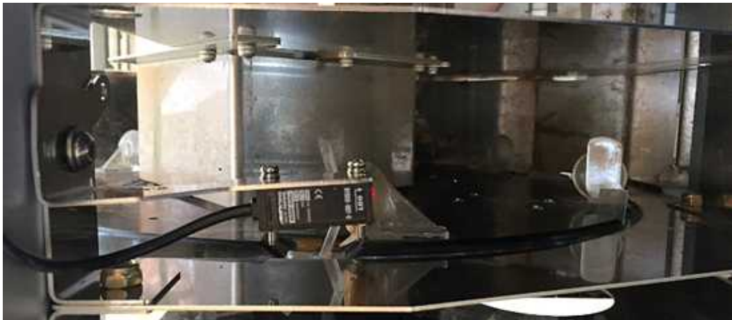
그림. 배종 센싱부 장착 사진
