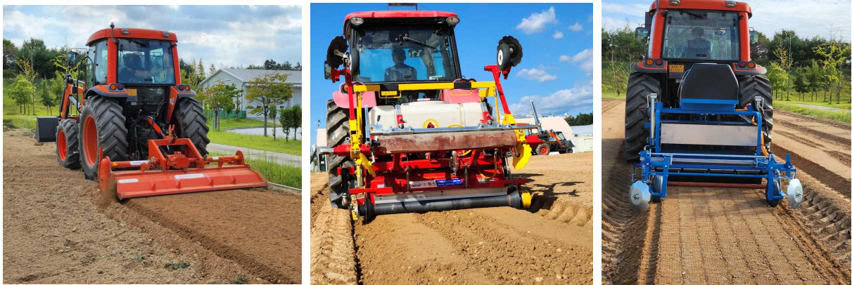
그림 20. 마늘파종기 표준 작업방법 현장실증시험(쇄토작업, 두둑성형, 마늘파종)
