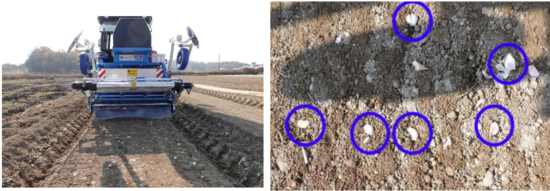
그림. Type2 조파식 파종기(좌), 거꾸로 파종률 0% (우)
