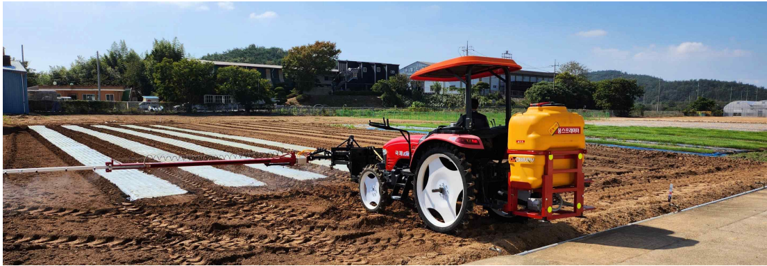
그림 17. 트랙터 부착형 붐방제기(현장실증 비닐피복 처리구 제초제 살포장면)
