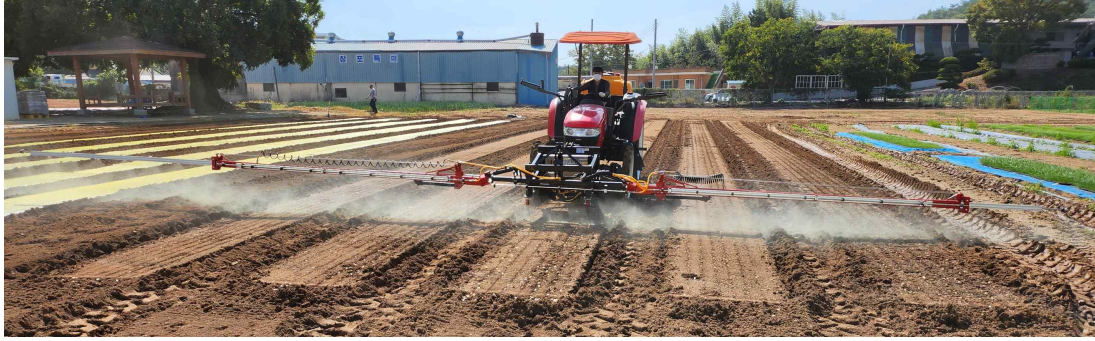
그림 16. 트랙터 부착형 붐방제기(현장실증 무피복 처리구 제초제 살포장면)
