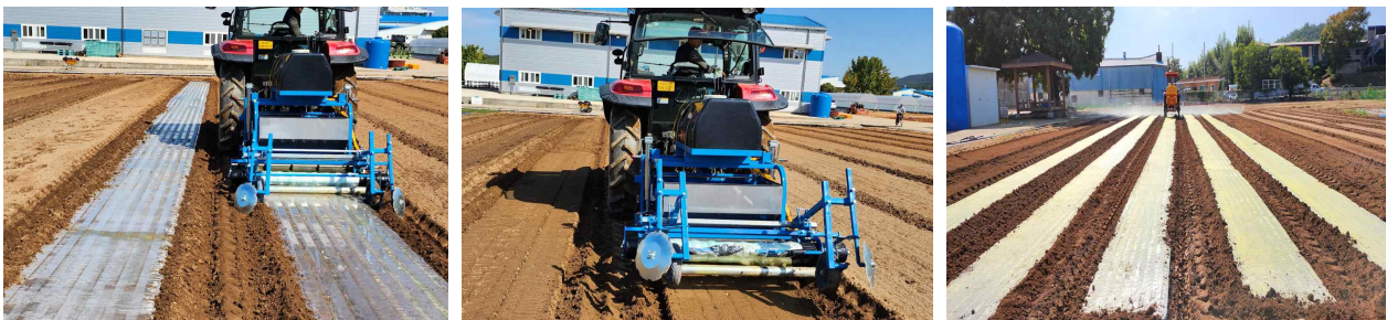
그림 22. 표준 작업방법 현장실증시험(두둑성형-제초제살포-마늘파종-비닐피복, 붐방제기 제초제살포)
