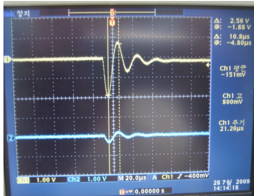
Fig. 26. 외부에서 2.0 kV 의 전압을 가했을 때 chamber 2 (좌) 와 chamber 4 (우) 에 유도되는 peak voltage 측정
