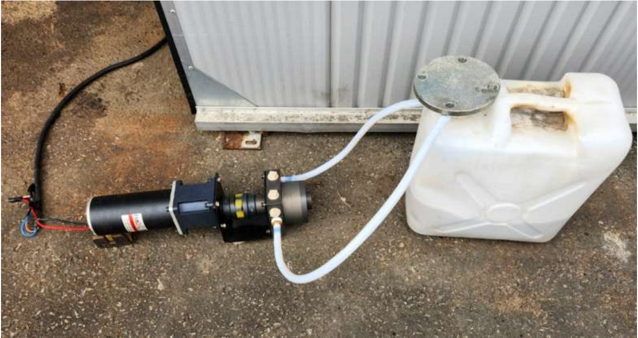
<그림> 끌어모음 구동모터 내구성 시험
