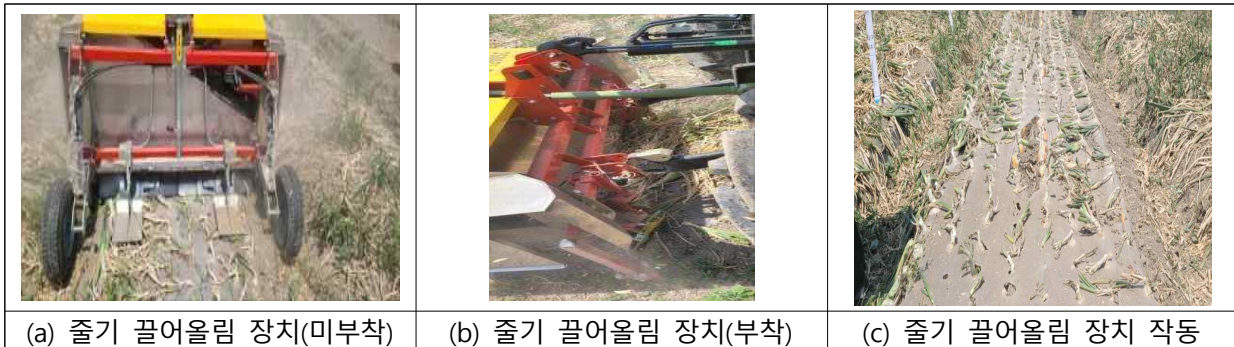
<그림> 줄기 끌어올림 장치 부착 여부에 따른 줄기절단 결과
