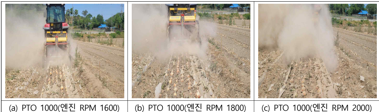
<그림> 엔진 회전수 변화에 따른 줄기절단 결과(마른 양파 줄기, PTO 1000rpm 고정)
