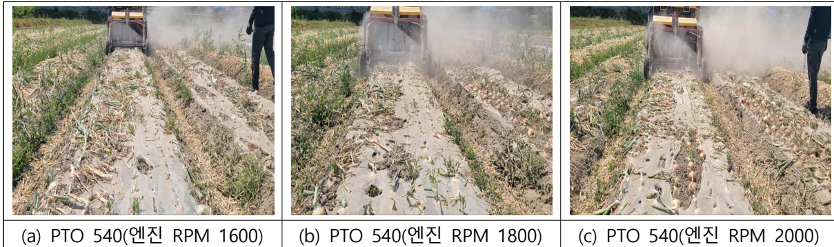
(a) PTO 540(엔진 RPM 1600) (b) PTO 540(엔진 RPM 1800) (c) PTO 540(엔진 RPM 2000) <그림> 엔진 회전수 변화에 따른 줄기절단 결과(덜 마른 양파 줄기, PTO 540rpm 고정)
