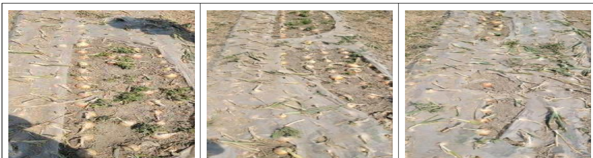
(a) PTO 750(엔진 RPM 1600) (b) PTO 750(엔진 RPM 1800) (c) PTO 750(엔진 RPM 2000)
