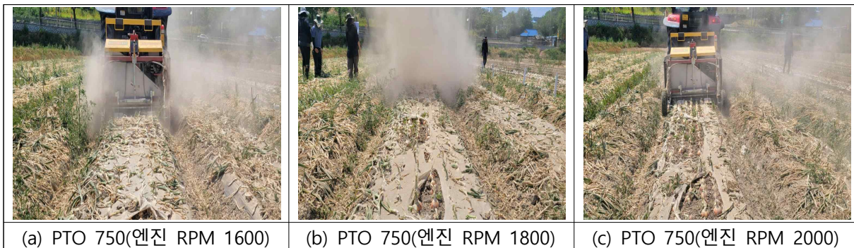
(a) PTO 750(엔진 RPM 1600) (b) PTO 750(엔진 RPM 1800) (c) PTO 750(엔진 RPM 2000) <그림> 엔진 회전수 변화에 따른 줄기절단 결과(덜 마른 양파 줄기, PTO 750rpm 고정)
