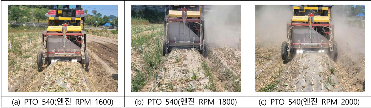
<그림> 엔진 회전수 변화에 따른 줄기절단 결과(마른 양파 줄기, PTO 540rpm 고정)
