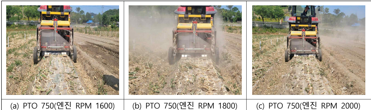
<그림> 엔진 회전수 변화에 따른 줄기절단 결과(마른 양파 줄기, PTO 750rpm 고정)
