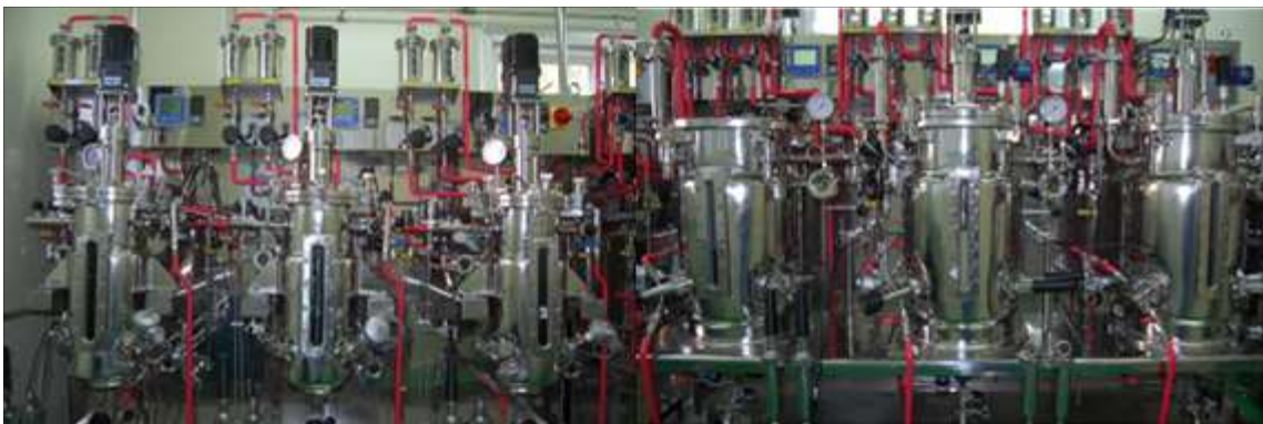
그림 7. 반려동물 유래 프로바이오틱스 균주 4 종의 Lab scale 배양을 위한 발효기 15 L, 30 L 발효기
