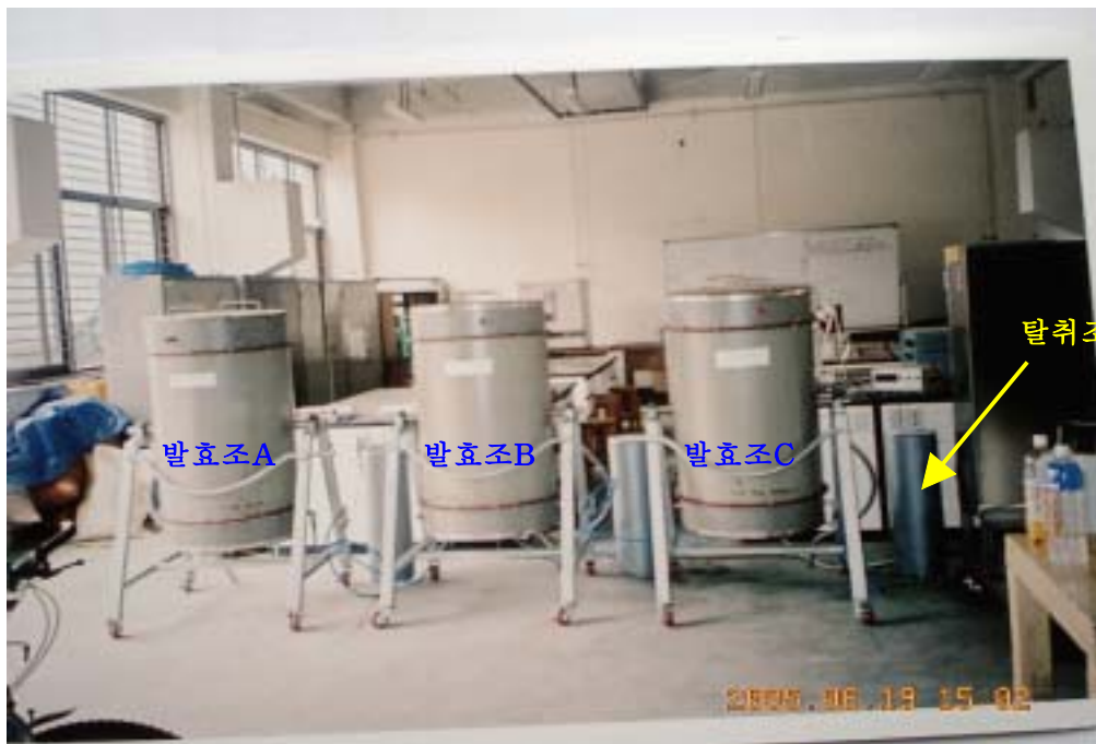
그림 4-4. 발효조의 개략도(상) 및 퇴비화 시스템(하)
